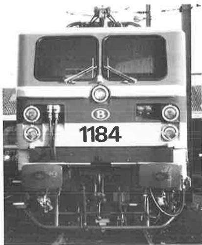
Een foto van het front van de 1184 toont duidelijk, dat de reeks 11 over slechts twee verbindingkabels en twee stekkerdozen voor meervoudige tractie beschikt (zie de ombouwbeschrijving). Brussel-Zuid, 31 december 1985. Foto Max Delie.
