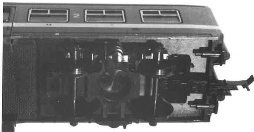
Een M4B van Lima na het aanbrengen van de Ribu-kortkoppeling. Foto Guy Van Meroye.
