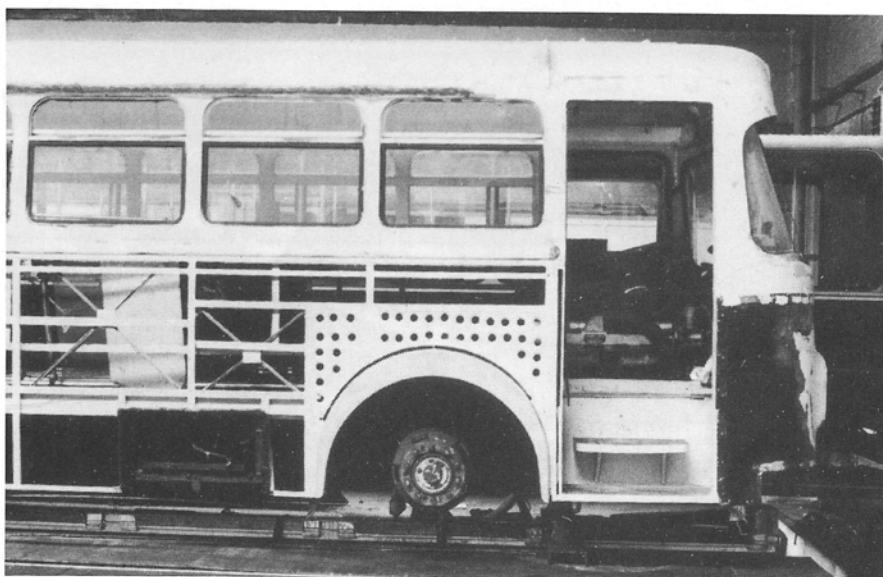
Garage Autobus De Polder N.V. - Autobus 52 tijdens de restauratie. De bus werd ontdaan van het plaatwerk, teneinde ook het koetswerkgeraamte een grondige beurt te kunnen geven. 4 februari 1986. Foto Eric Keutgens.
