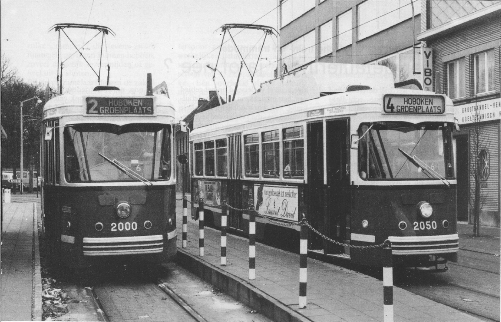
Een „toevallige” ontmoeting tussen de eerste Antwerpse PCC 2000 en de 2050, het testrijtuig met wisselstroommotoren en een electronische uitrusting voor de toekomst. De op het dak van de 2050 ondergebrachte apparatuur bezorgde dit rijtuig de bijnaam „Kamel” (kameel). Hoboken, Lelieplaats, 20 december 1984. Foto Eric Keutgens.
