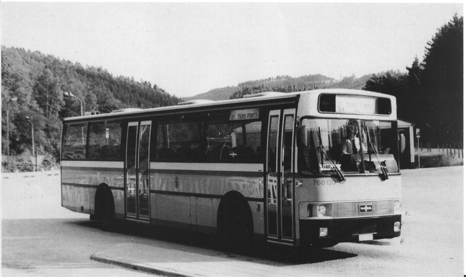
Autobus 760120 van de firma José Wergifosse & Cie s.p.r.l. Gebouwd op een Daf MB 205 DKFL 600 onderstel, voorzien van een Van Hool „Alizée” koetswerk. In 1984 aangekocht, wordt ze ingezet op de lange lijn 42a Liège-Trois Ponts-Gouvy. Foto van Charles Smits aan het station van Trois Ponts.
