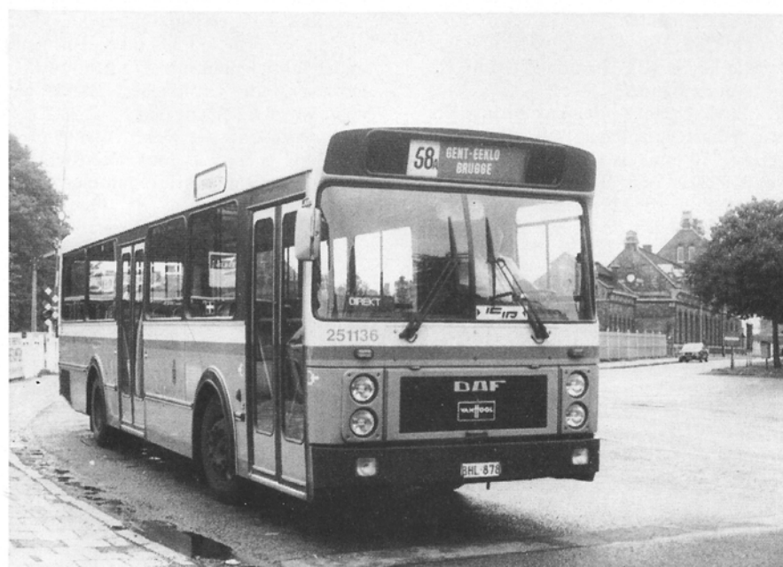
Autobus 36: een Van Hool koetswerk naar het A.120.P model, gebouwd op een Daf SB 210 DKL 550 onderstel. Foto genomen aan de halte Wondelgem station. Deze halte wordt zowel door lijn 252 als door lijn 58a bediend. Foto Autobus-archief Ch. Smits.
