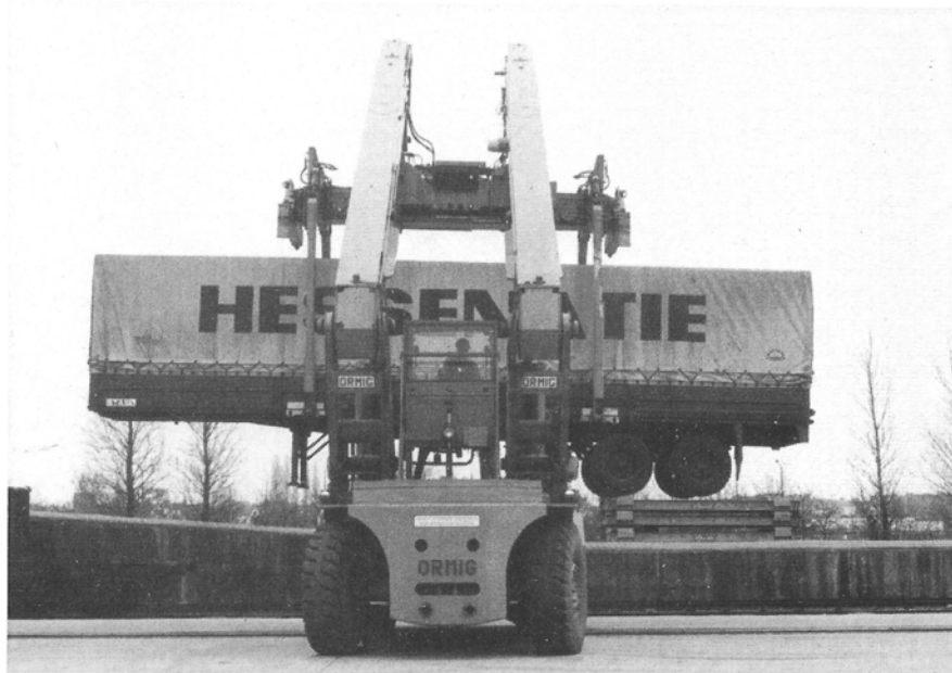
Voorbeeld van „vertikale behandeling” bij de firma TRW te Antwerpen-Schijnpoort. De speciale kraan heeft een hefvermogen van 40 ton. Foto Staf Cuyt.
