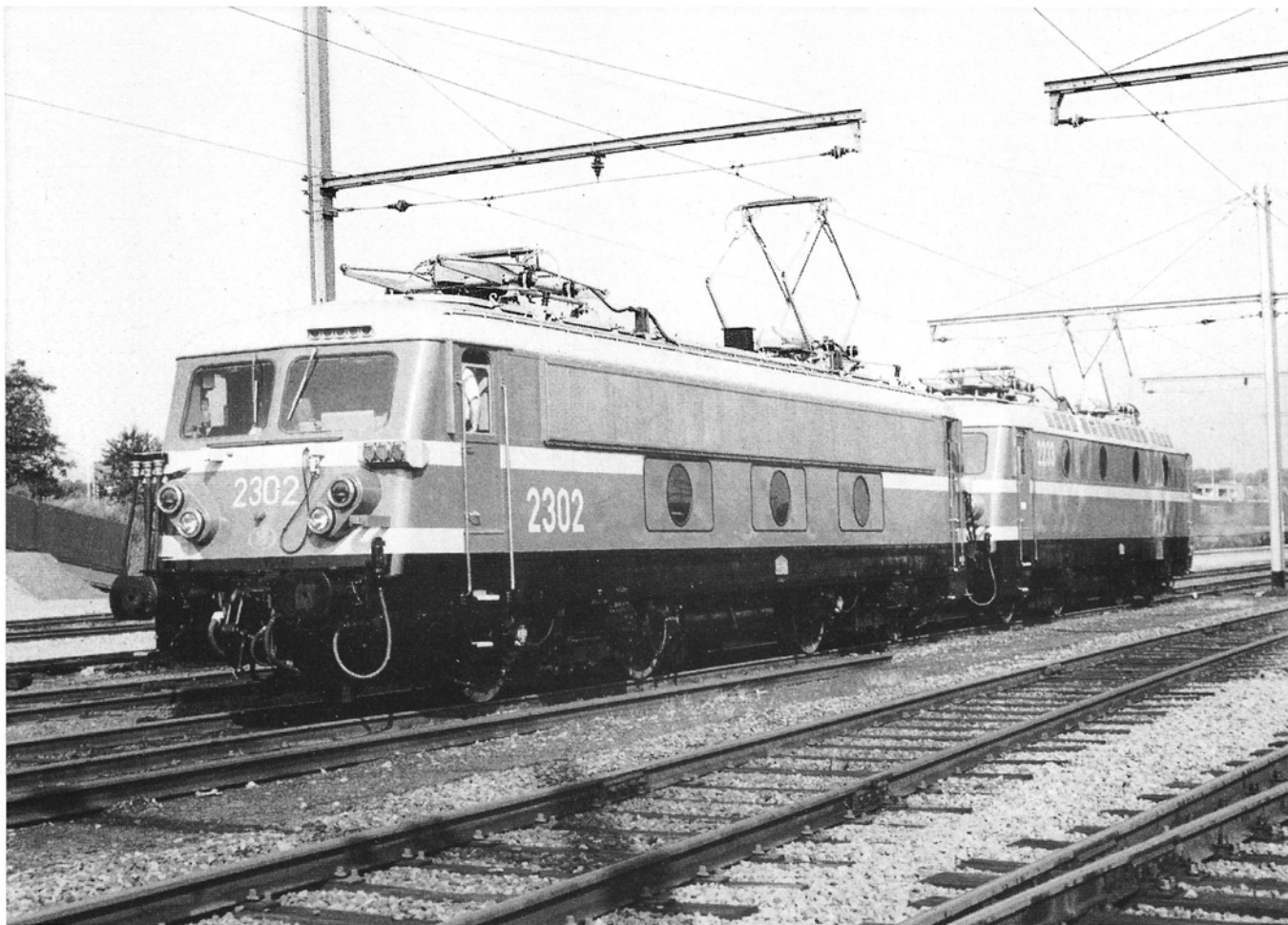
2302, na verbouwing op proefrit, vergezeld van 2233. „Duikboot” 2302 is de enige lok van de oudere generatie met overlangs verluchttingsrooster. 7 juli 1983. Foto Jan Mahieu.
