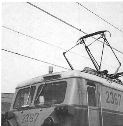
Detail van de 2367 met lijnradio-antenne op het dak. Foto Jan Mahieu.
