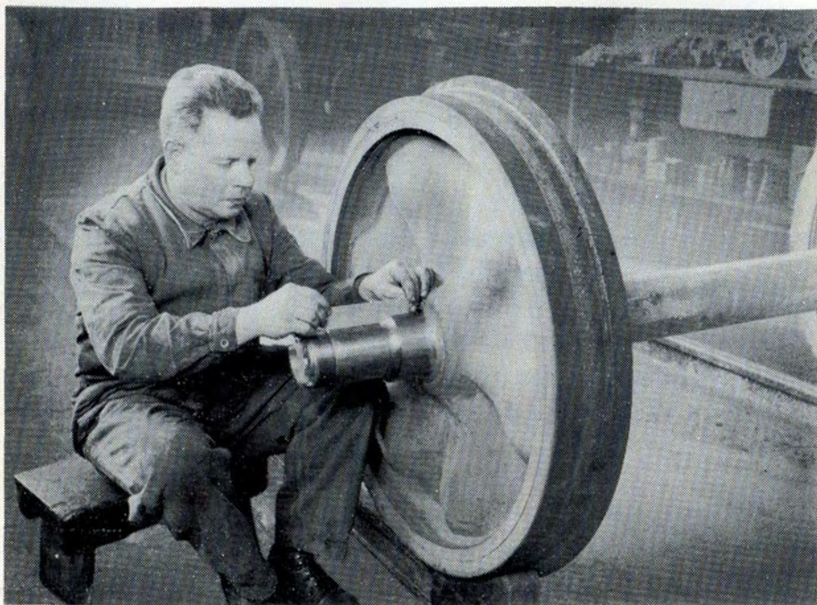
Fig. 7. Vérification à l'aide d'un gabarit du profil de la fusée.
