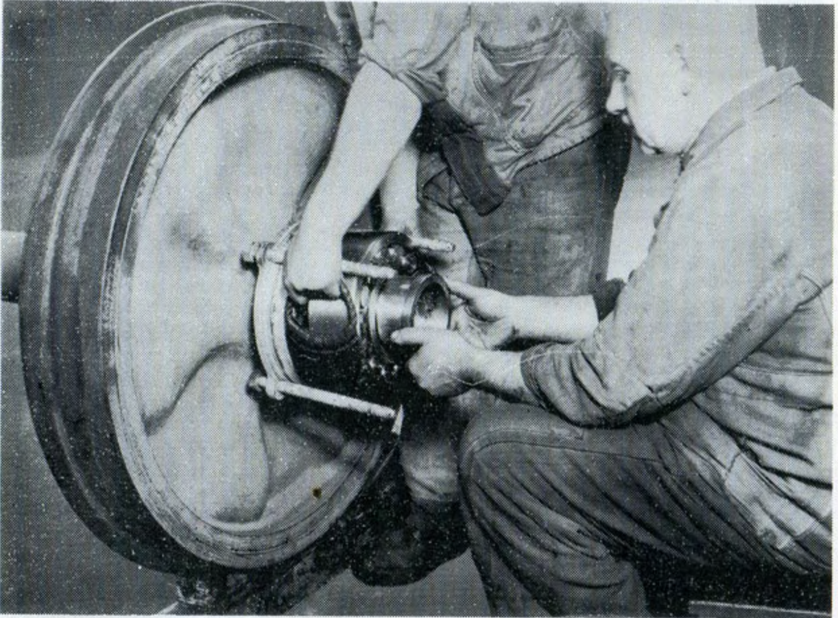
Fig. 15. Mise en place sur la fusée du roulement et du manchon de démontage.
