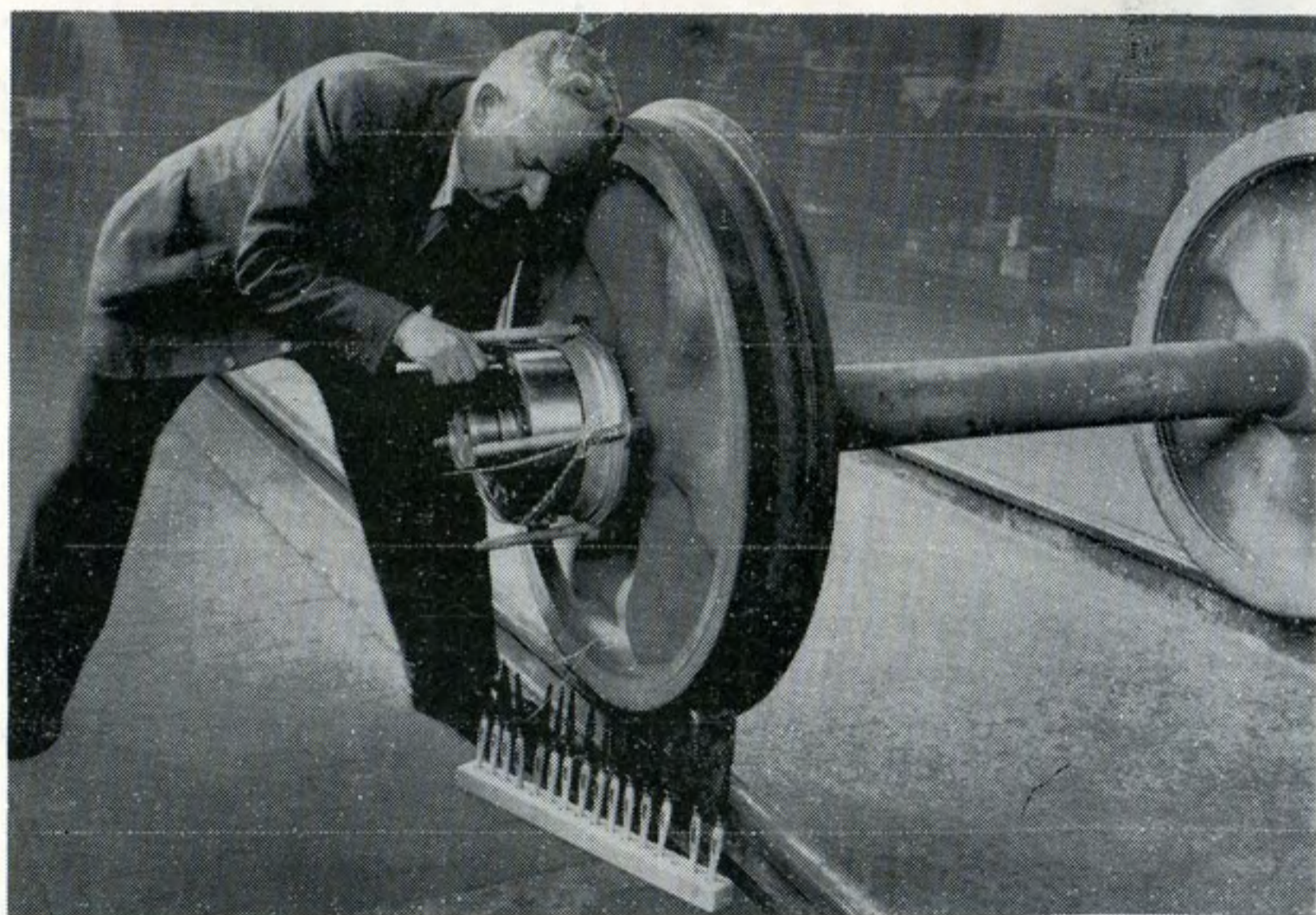
Fig. 17. Contrôle de l'enfoncement du manchon par mesure de la réduction du jeu du roulement. Sur le sol, une série de lames calibrées.
