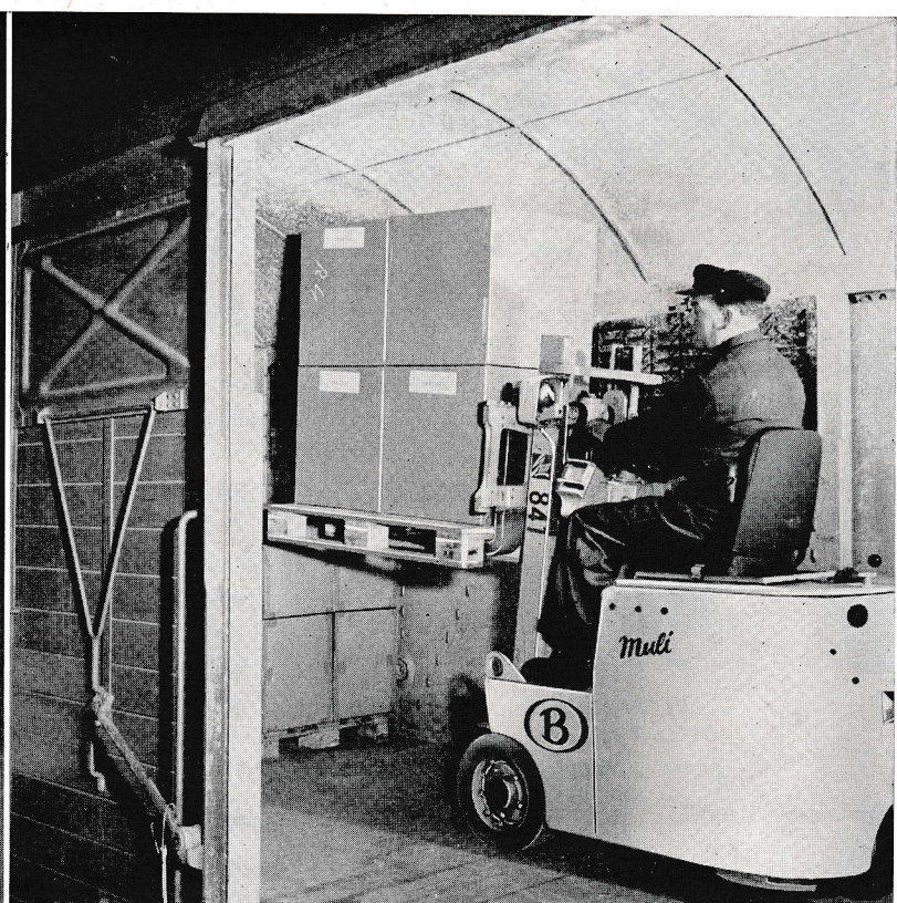
Stapelning der gepalletiseerde colli in de wagens door middel van de vorkheftruck.
