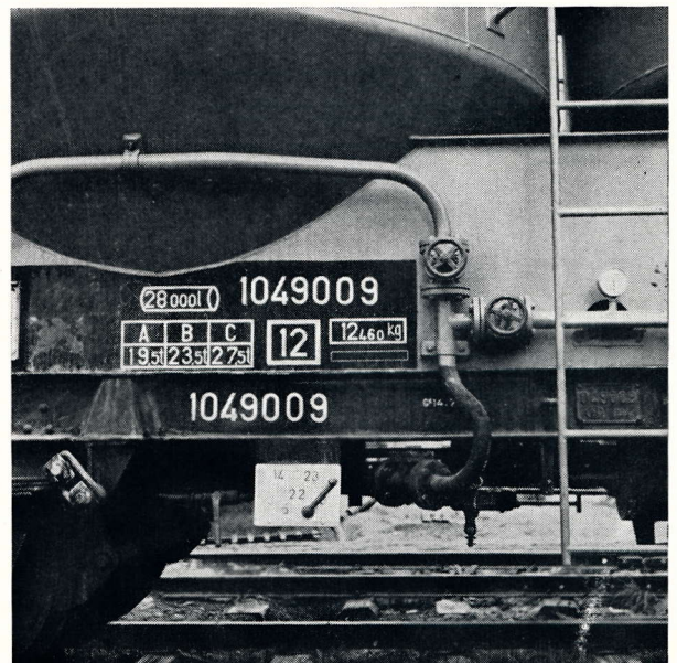
De karakteristieken van de wagen. Door de ladder bemerkt men de manometer — links daarvan de kranen voor luchttoevoer naar de ketel en naar de cementafvoerleiding.
