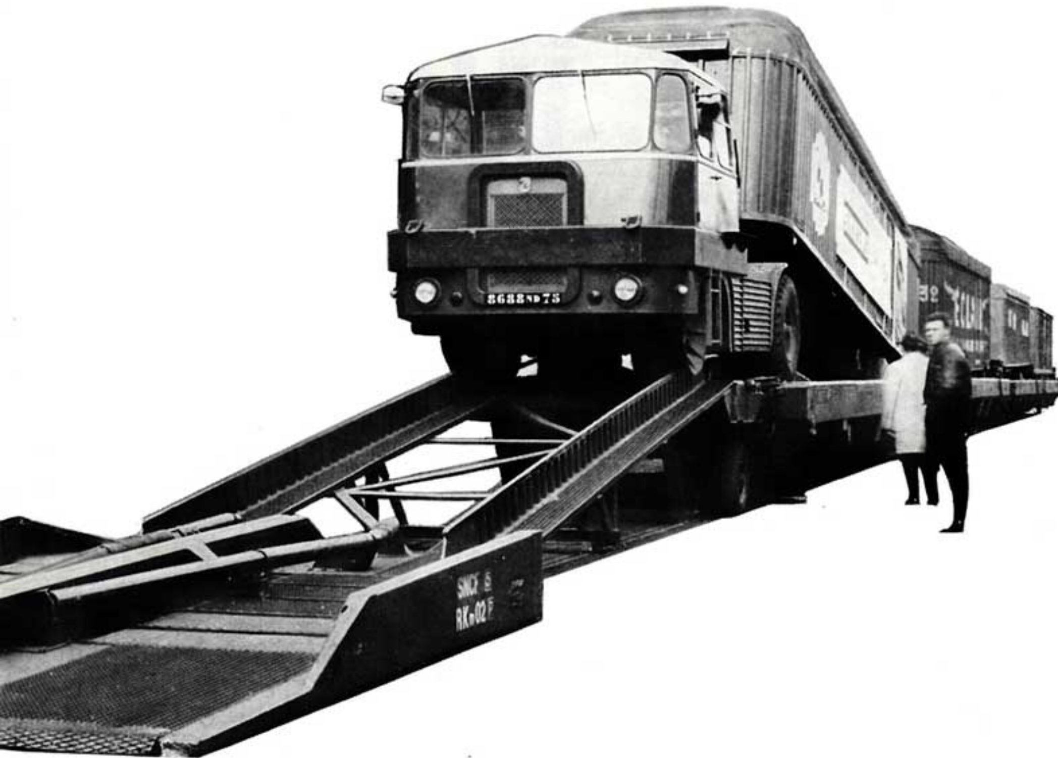
▲ Figuur a : „Kangoeroe” systeem. Looprails in hoge stand (links), in lage stand (rechts).
