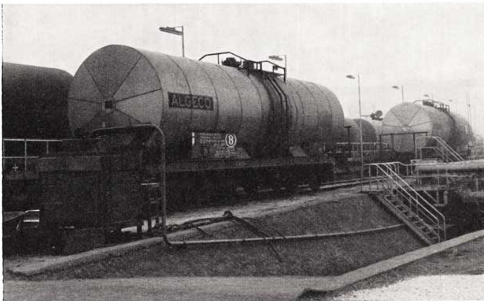
Lossen van een ketelwagen met warmte-isolering bij de firma ARBED, fabriek van Belval.
