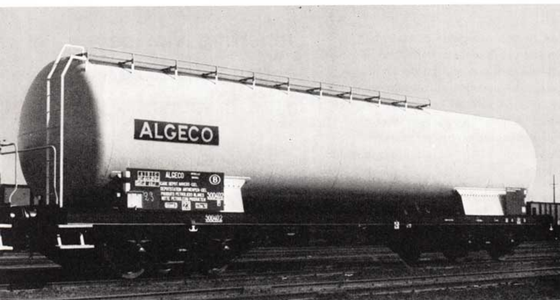
Ketelwagen met draaistel voor het vervoer van lichte petroleum-produkten.
