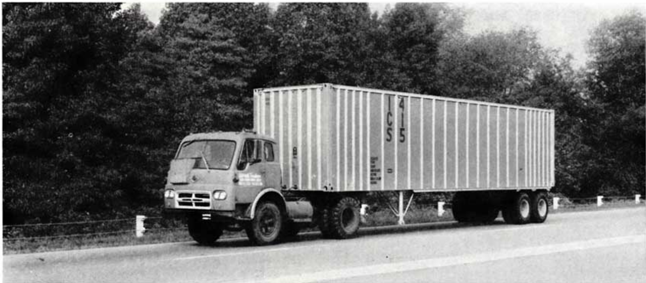
„Flexi-Van“ container compleet met afneembaar wielstel en tractor.
