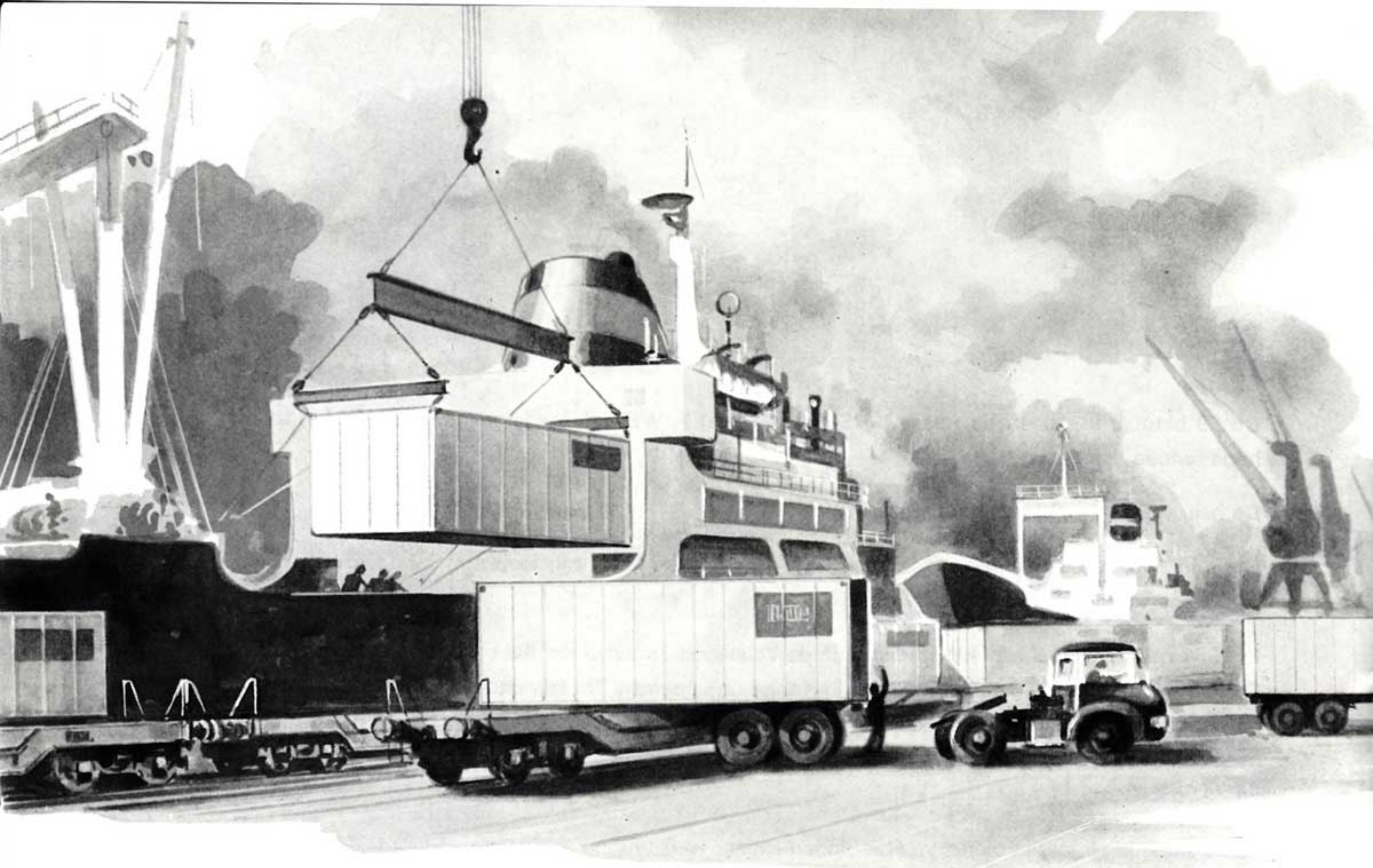
Synthese van het "Flexi-Van" systeem.
