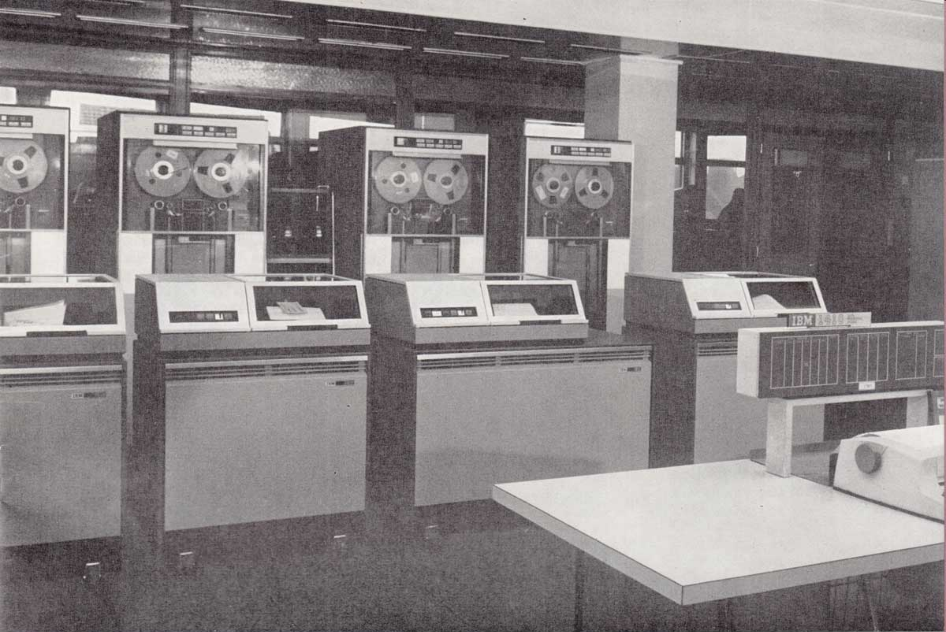
Magnetische hulpgeheugens van de centrale computer.
