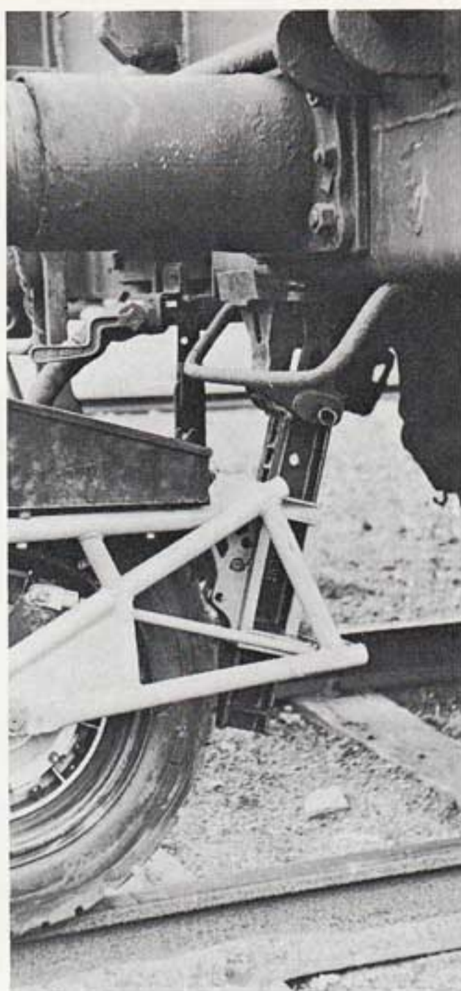
De duwkop wordt tegen de wagen geplaatst.
