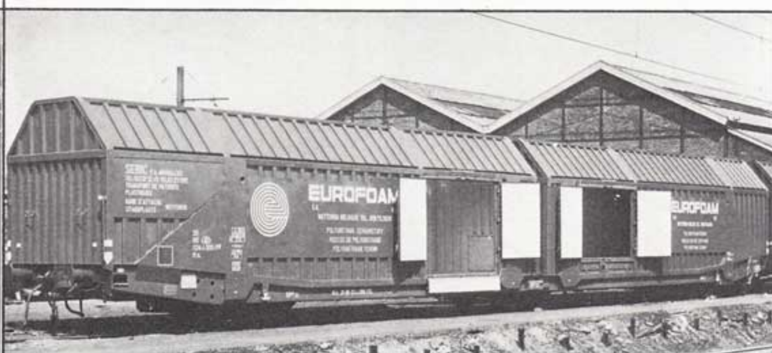
Gesloten, 3-assige gelede wagen voor het vervoer van goederen met zeer gering soortelijk gewicht
