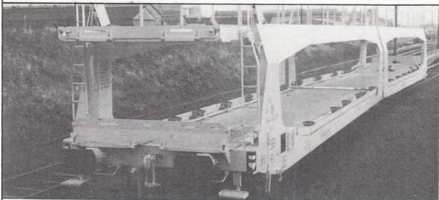
Gelede, 3-assige, dubbeldekwagen voor het vervoer van auto's
