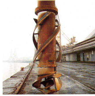
5. 2 Siwertell-schroeflosapparaten om granen te lossen.
