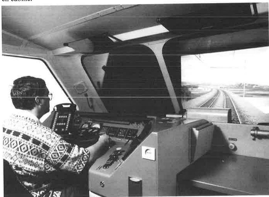
Un conducteur de trains opère sur le simulateur de conduite (doc. SNCB)
