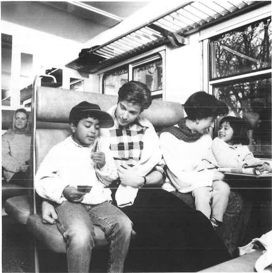
Aménagement intérieur de 2ème classe d'une voiture M4 rénovée : les portebagages latéraux ont été supprimés au profit d'un modèle longitudinal ; les banquettes restent... (doc. SNCB)
