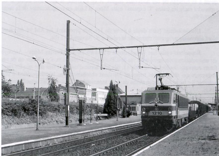
**Un train de marchandises Gent-Zeehaven - Lille-Délivrance, tracté par la 1210, passe à Mouscron, voie 2, le 12 juillet 1995 : à l'extrême gauche, on distingue nettement la voie de gare latérale, électrifiée en 25 kV 50 Hz (photo M. Van Ussel)**
