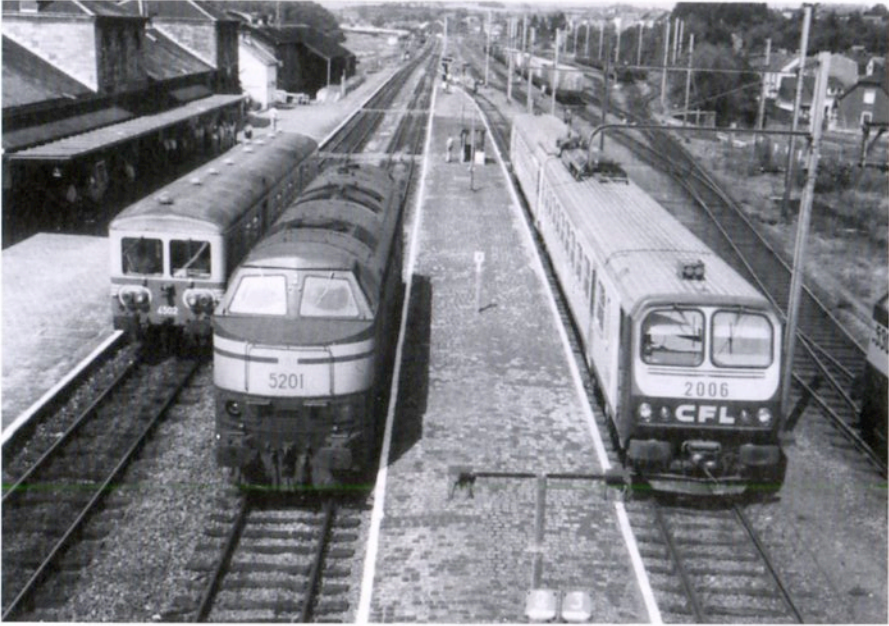
La gare SNCB d'Athus a déjà été électrifiée en 1961 en 25 kV 50 Hz par les soins et aux frais des CFL (photo R Marganne - 25/7/92)
