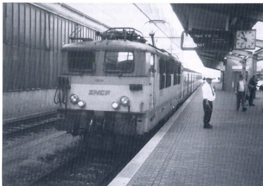
Luxembourg, gare bicourant commutable secteur continu : automotrice SNCB « Break » 315 au départ voie 1 pour Bruxelles secteur alternatif : rame réversible « Metrolor » (type RIO) pour Nancy, au départ voie 10, remorquée par la BB 16 684 de la SNCF (photos R. Marganne - 29.05.99)
