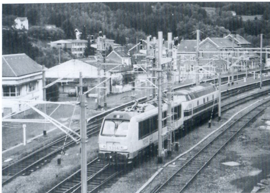
Essais de traction électrique 25 kV 50 Hz ~ à Trois-Ponts le 22.09.99 : locomotive SNCB 1314 sous tension et locomotive diesel 5528 en remorque pour le cas où... (photo M. Lamboray)
