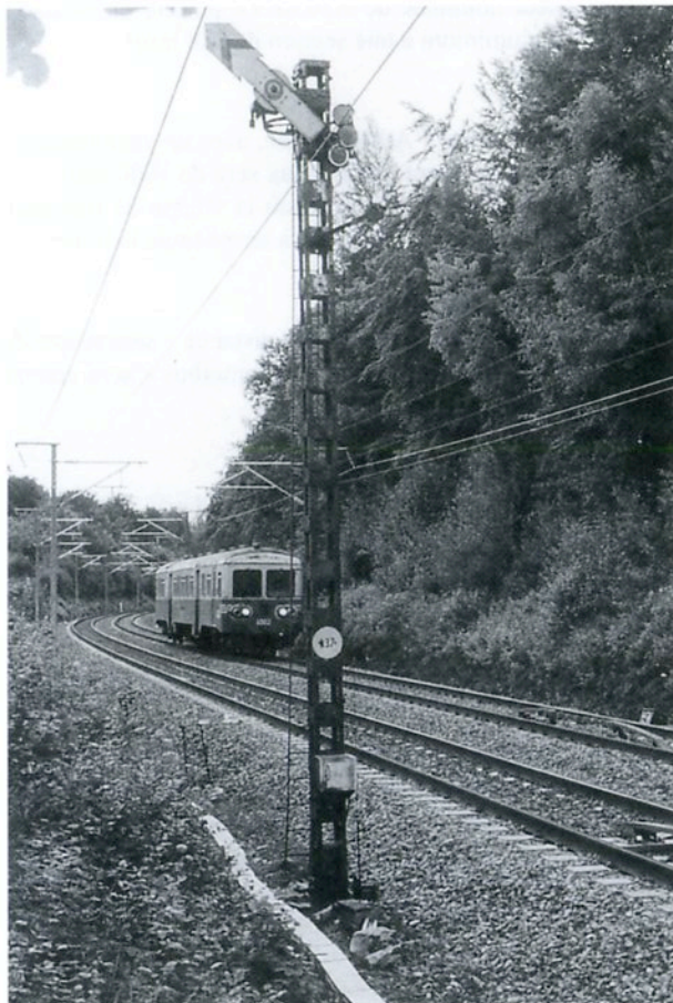
Passage de l'autorail 4502 en direction de Virton devant l'avertisseur mécanique k37 de Saint-Vincent-Bellefontaine (photo J. Perenon - 03.08.00)
