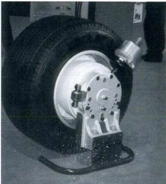
**Le bloc moteur roue Alstom-Michelin, avec à l'avant, les freins puis le réducteur et le moteur asynchrone. Le pied d'exposition est vissé là où se fixe la traverse (photo A. Spailier 06/97)**
