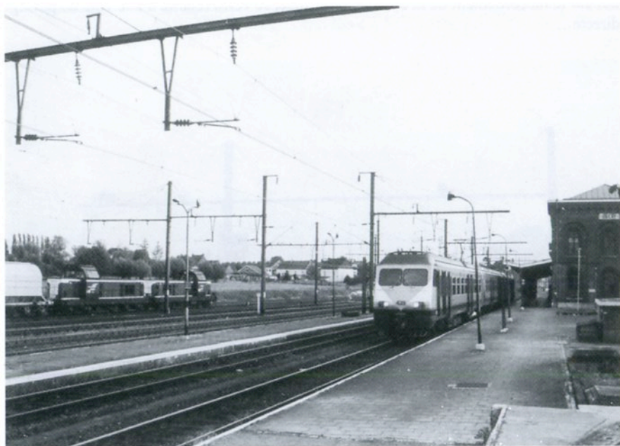
Quévy le 23.05.00 : voie 1, sous 3 kV, train IR Quévy – Aéroport national (automotrice SNCB 439) – en arrière-plan, BB 66 201 et 66 223 SNCF en tête d'un train de fret pour la France (photo M. Grieten)
