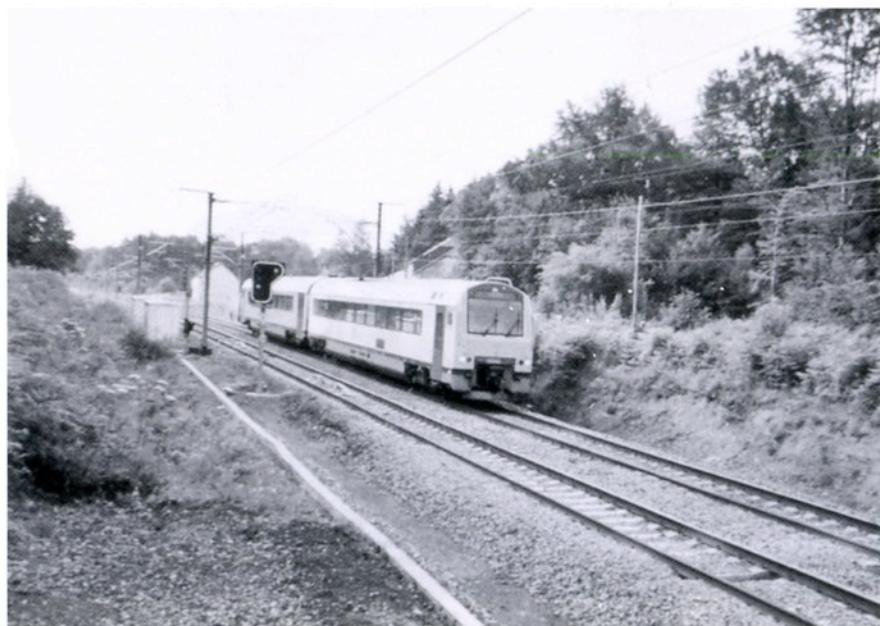
Saint-Vincent-Bellefontaine, BK 104,2 : début de la zone de signalisation télécommandée par le poste informatique de Bertrix. Un autorail en direction de Virton passe au droit des signaux avertisseurs provisoires t-r23 et tx-r23 le 30/07/2002 à 16h30 (photo R Marganne – J. Perenon)
