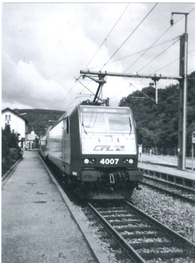
Image de la traction moderne aux CFL : locomotive bifréquence 15/25 kV 4007 en tête du train IR Troisvierges – Luxembourg à l'arrêt à Kautenbach (photo R. Marganne – 11.08.06)
