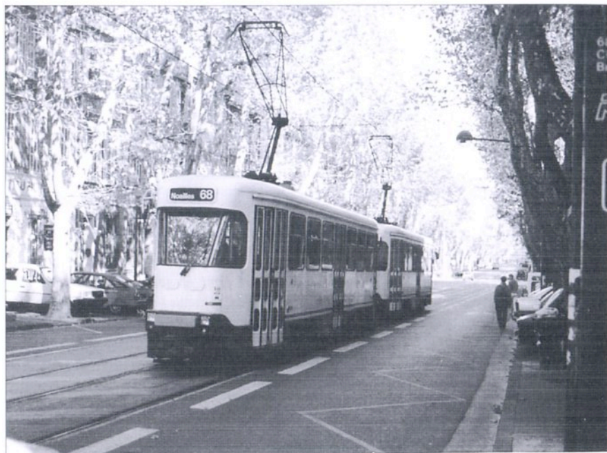
Marseille : une rame de PCC de la première tranche circulant en UM2 sur le boulevard Chave. On remarque l'étréoussse des archets du pantographe due au gabarit du tunnel de Noailles. Photo © Jean EVRARD
