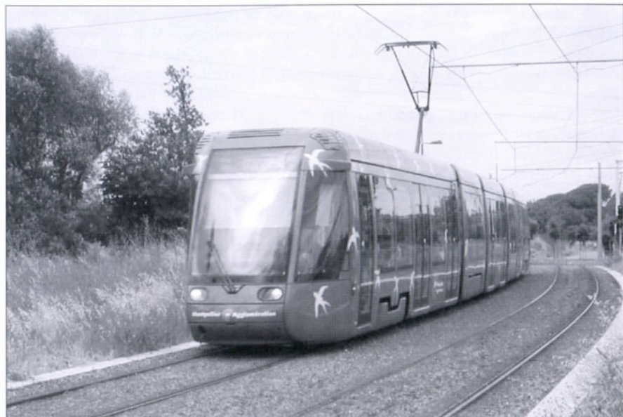
Une rame "301" allongée en "401" en site propre sur la ligne 1 - Photo © J.-P. FOURNIER
