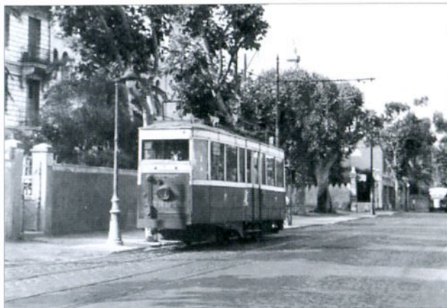
Nice : motrice "type L" à 2 essieux datant de 1925, en service jusqu'en 1951 - Cliché X - Collection © AMTUIR
