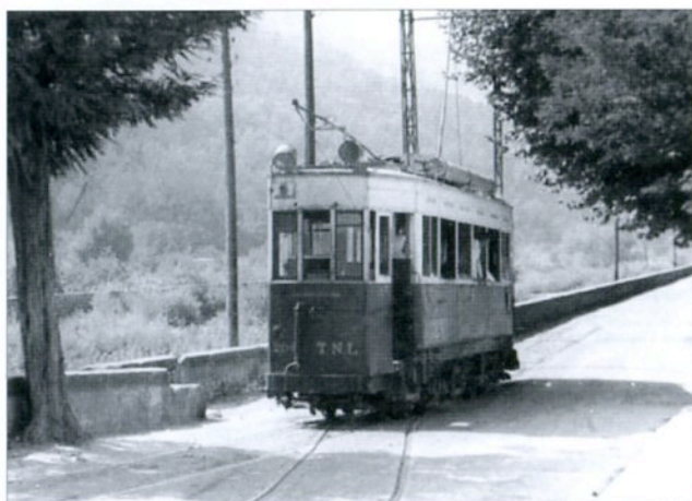
Nice : sur la ligne 37 Nice-Contes des TNL en 1949 : motrice 204 à bogies Thomson-Houston en service de 1910 à mai 1950. Cliché LAURENT - Collection © AMTUIR
