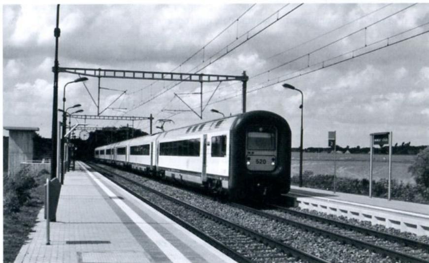
**Nouveau point d'arrêt de Mamer-Lycée (G-D. Lux.) : passage des AM SNCB 520 et 505 assurant le train IC Bruxelles – Luxembourg le 12.08.05. Remarquons la suspension de la caténaire 3 kV, préparée pour transformation ultérieure prévisible en 25 kV 50 Hz (photo Ch.-L. Mayer)**
