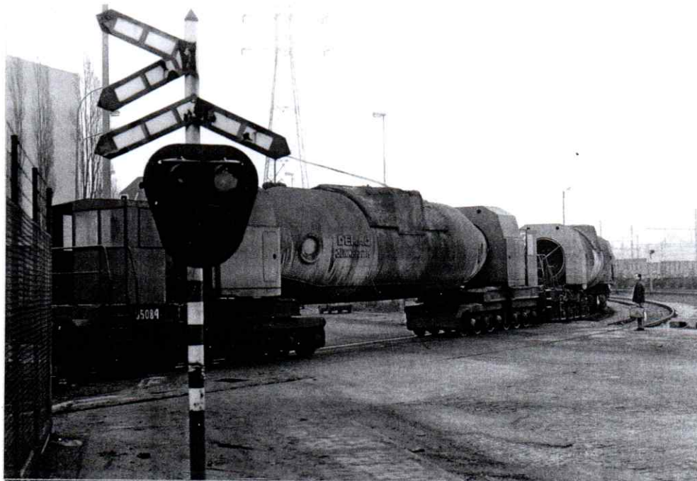
Hg. poche fonte no 34 en 1986 et no 91 en 2000 ex poches longues Hainaut-Sambre et provenance de Hainaut-Sambre + sur le même chassis no 65084 photo datée mars 1986 Charleroi/TMP
