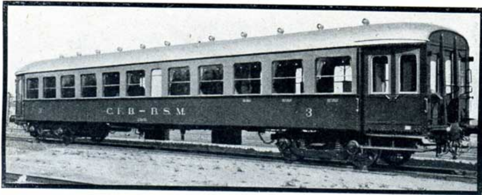
Voiture métallique type bloc service intérieur.
