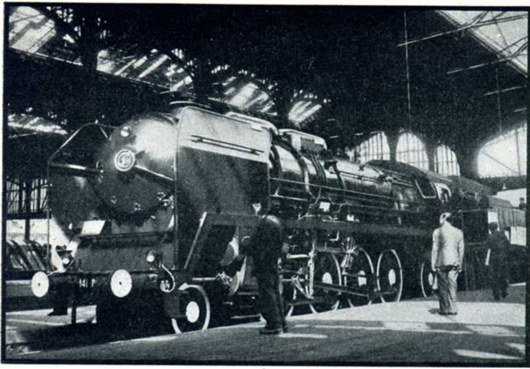
Locomotive 141 P de 3.400 CV. à la jante, pour service mixte, pouvant remorquer 700 T. à 100 km/h sur des lignes à 5 ‰. Machine munie d'un chargeur mécanique. (Cliche S.N.C.F.)
