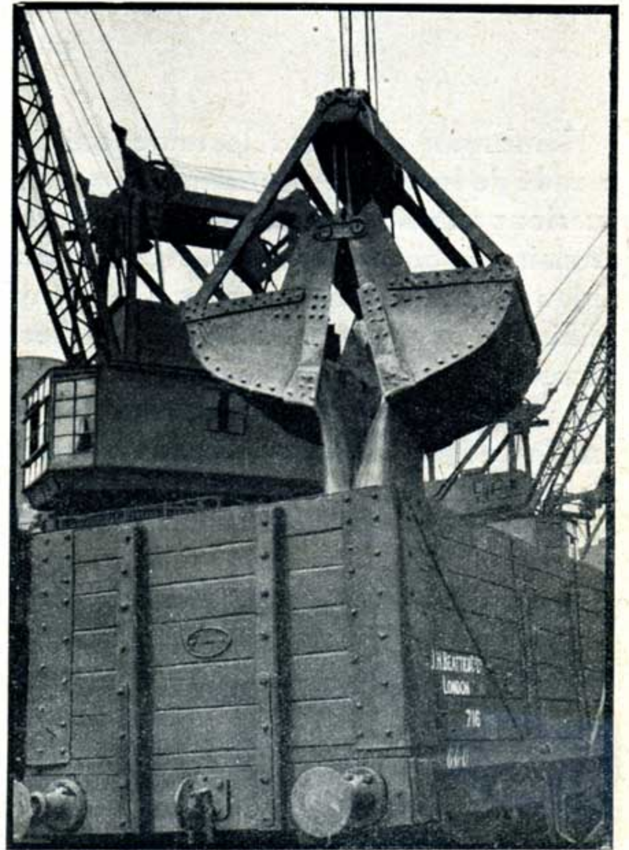
Grappin de grue transférant de l'antimoine de la cale d'un navire au rail.
