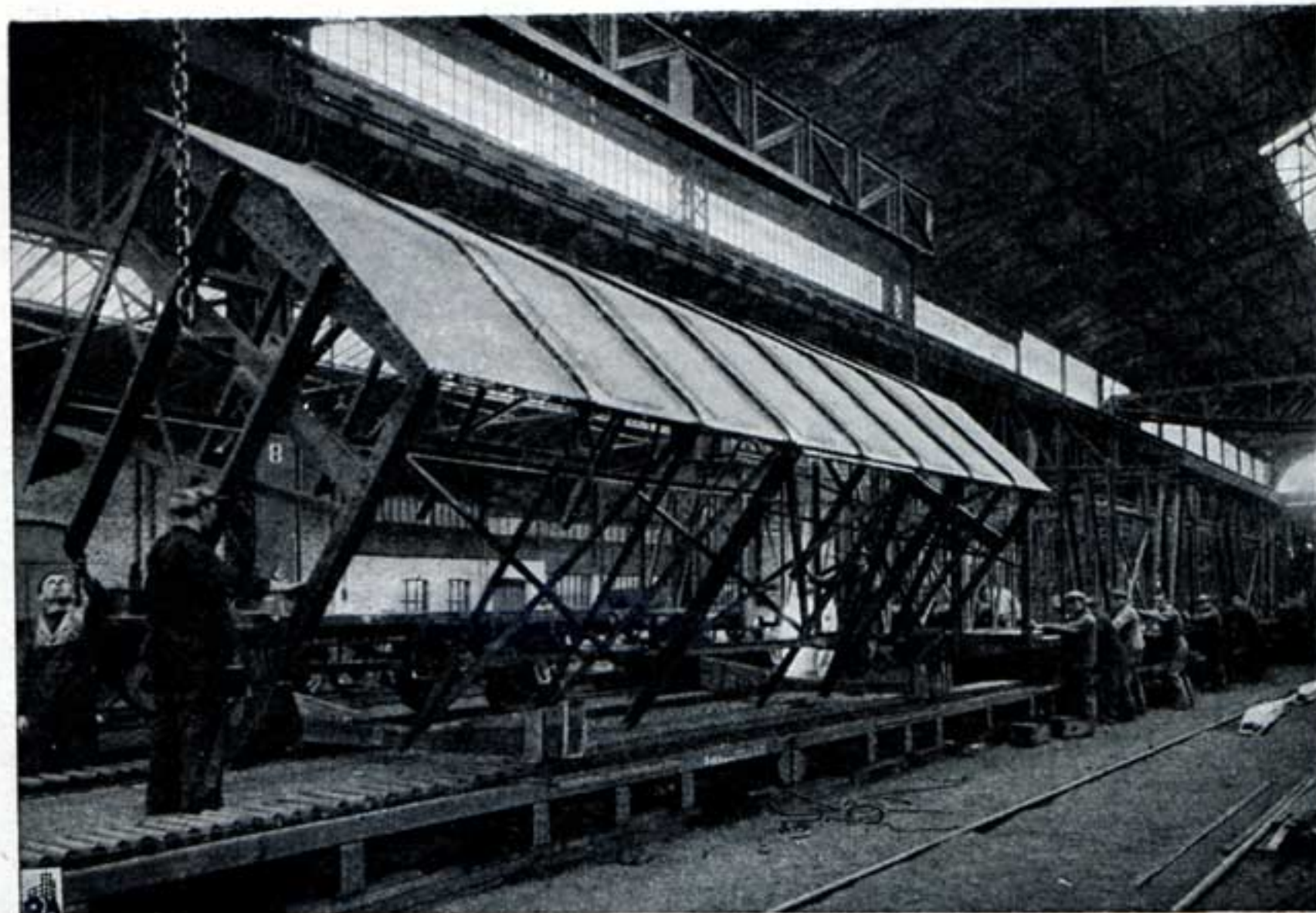
Fig. 6. Montage à la chaîne des wagons fermés.
