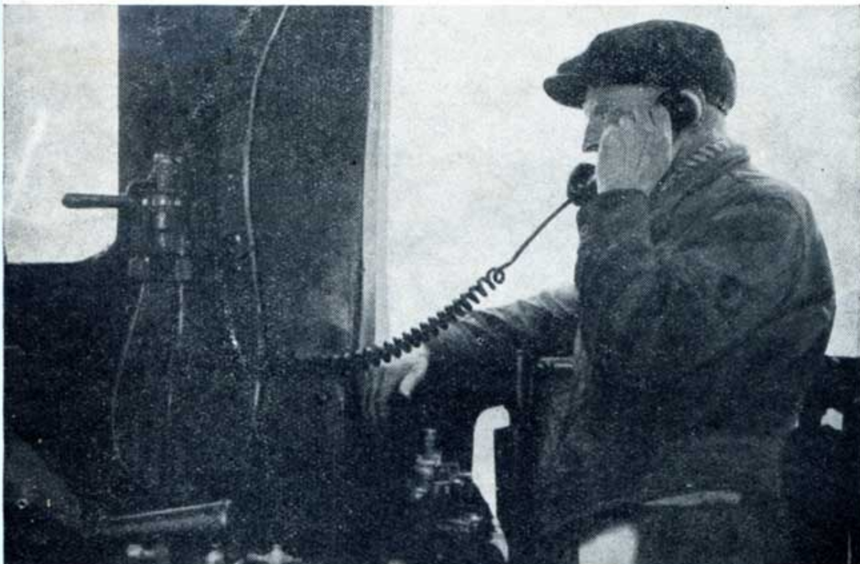
Fig. 25. — Poste émetteur-récepteur à bord d'une locomotive.
