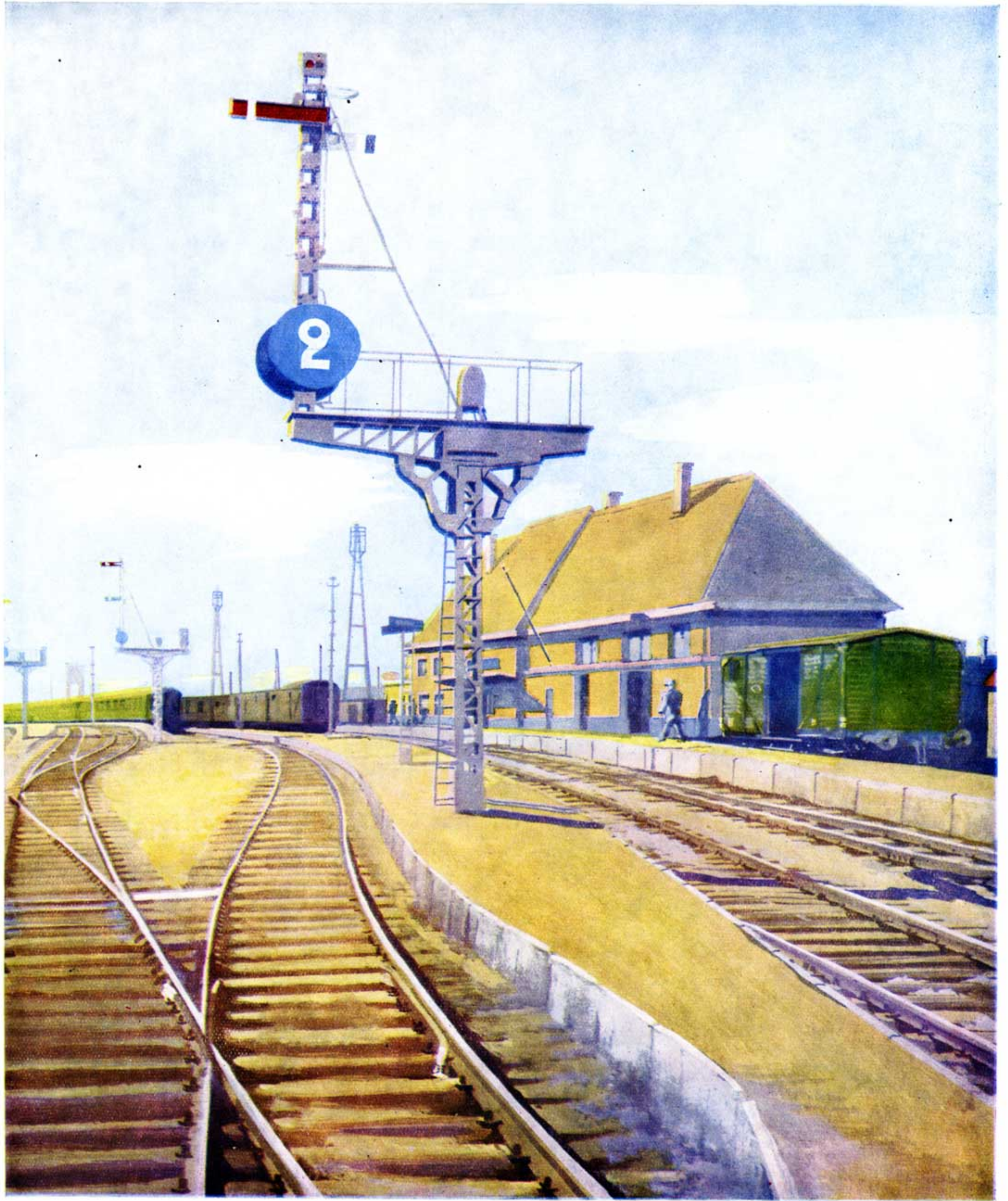
Signalisation à palettes à 3 positions.
