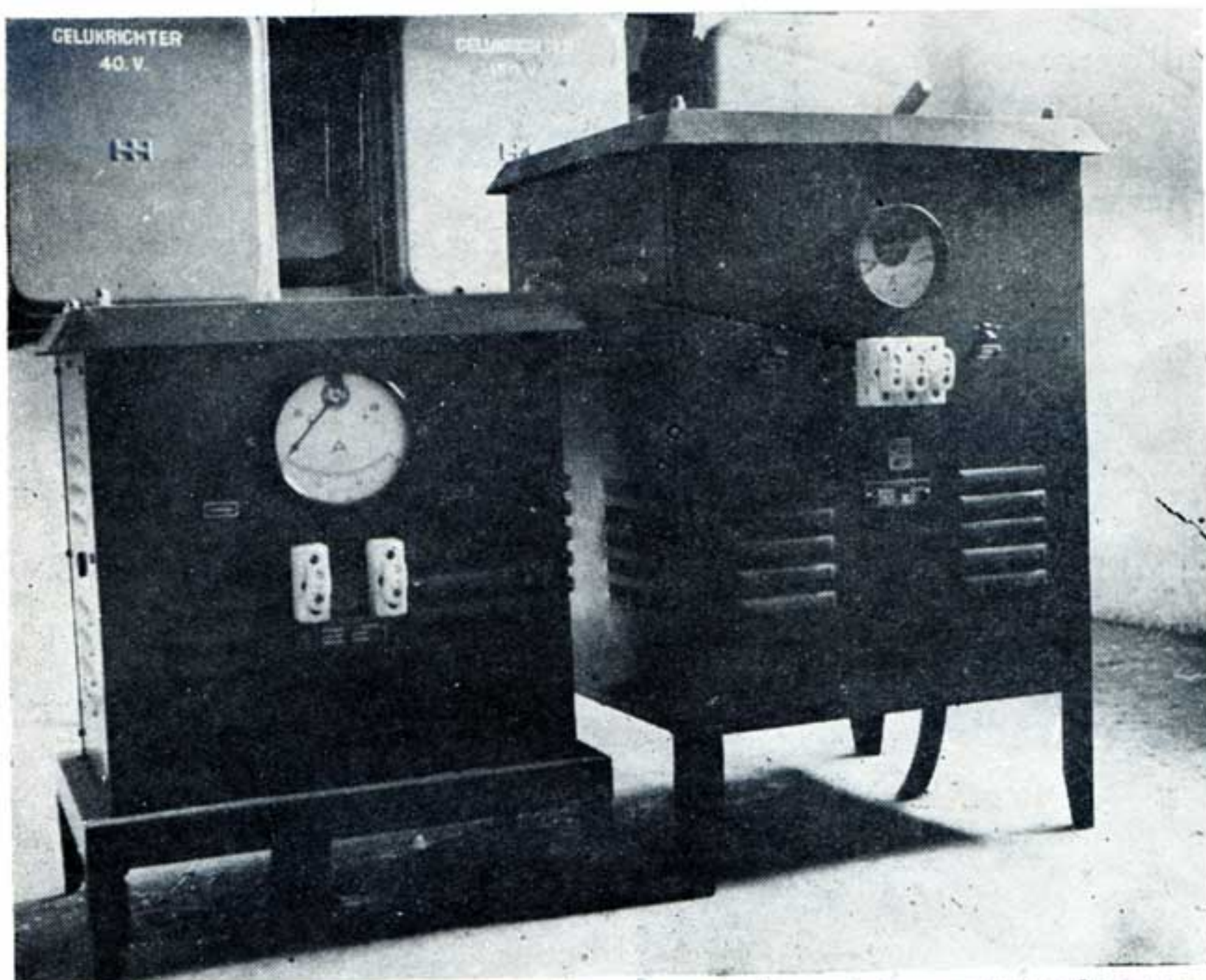
Fig. 37. — Redresseurs statiques remplaçant les accumulateurs.
