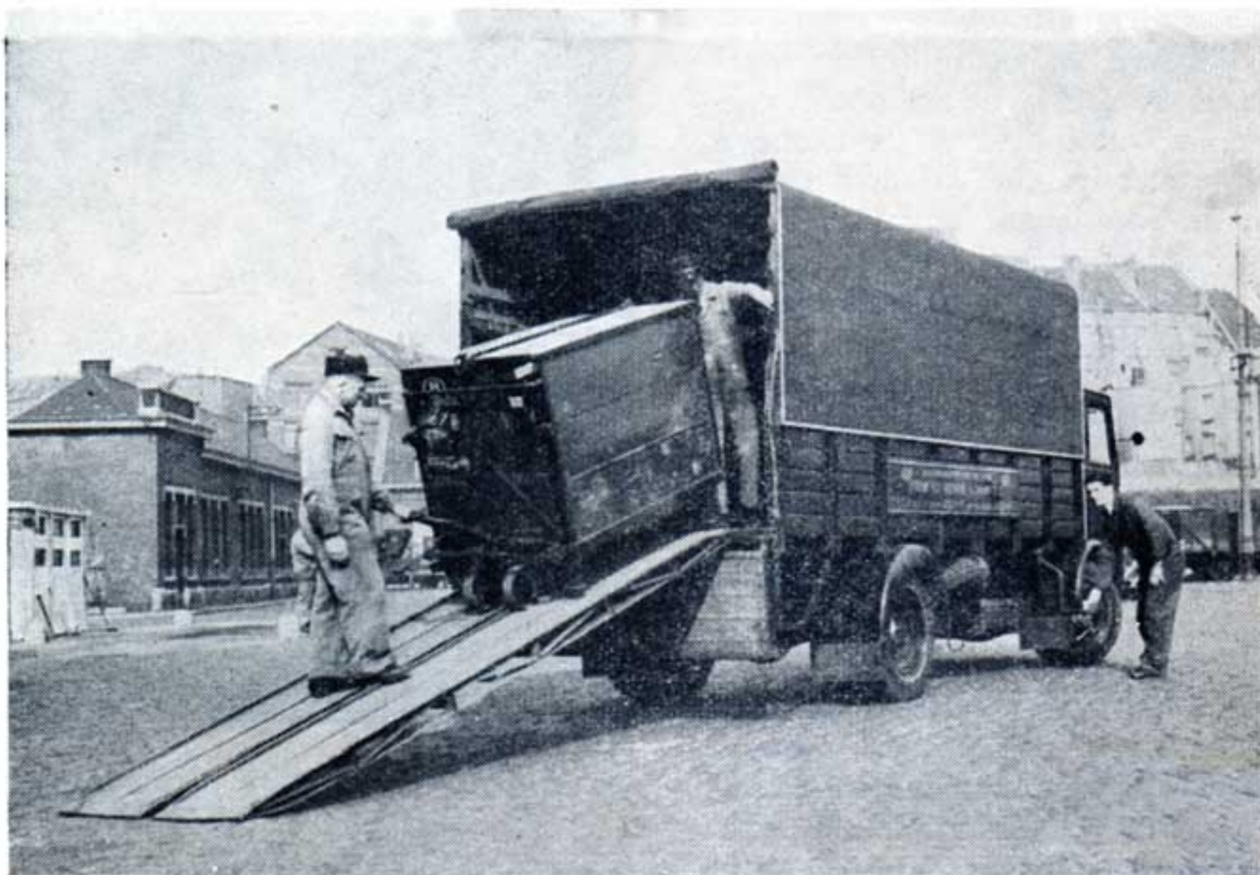
Fig. 6. — Chargement de containers sur camion.
