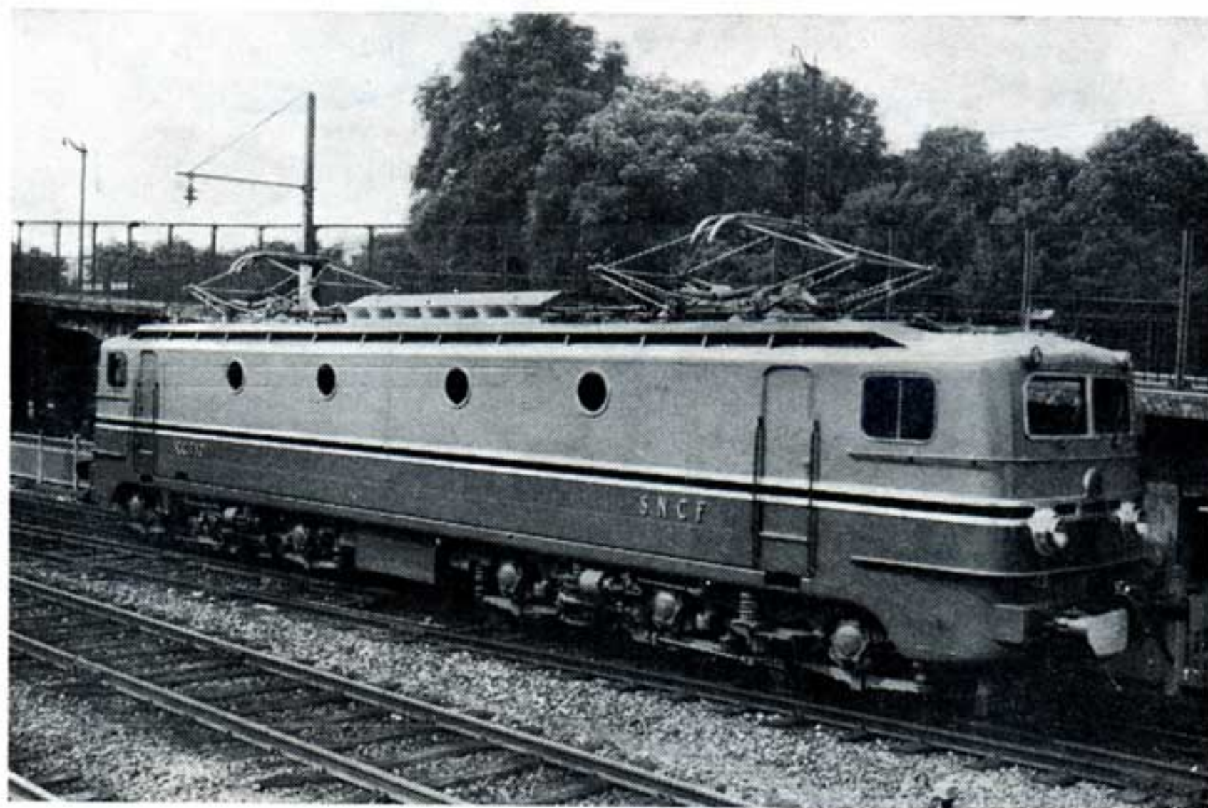
Fig. 2. — Locomotive CC à 140 km/h. pour remorquer des trains rapides.
