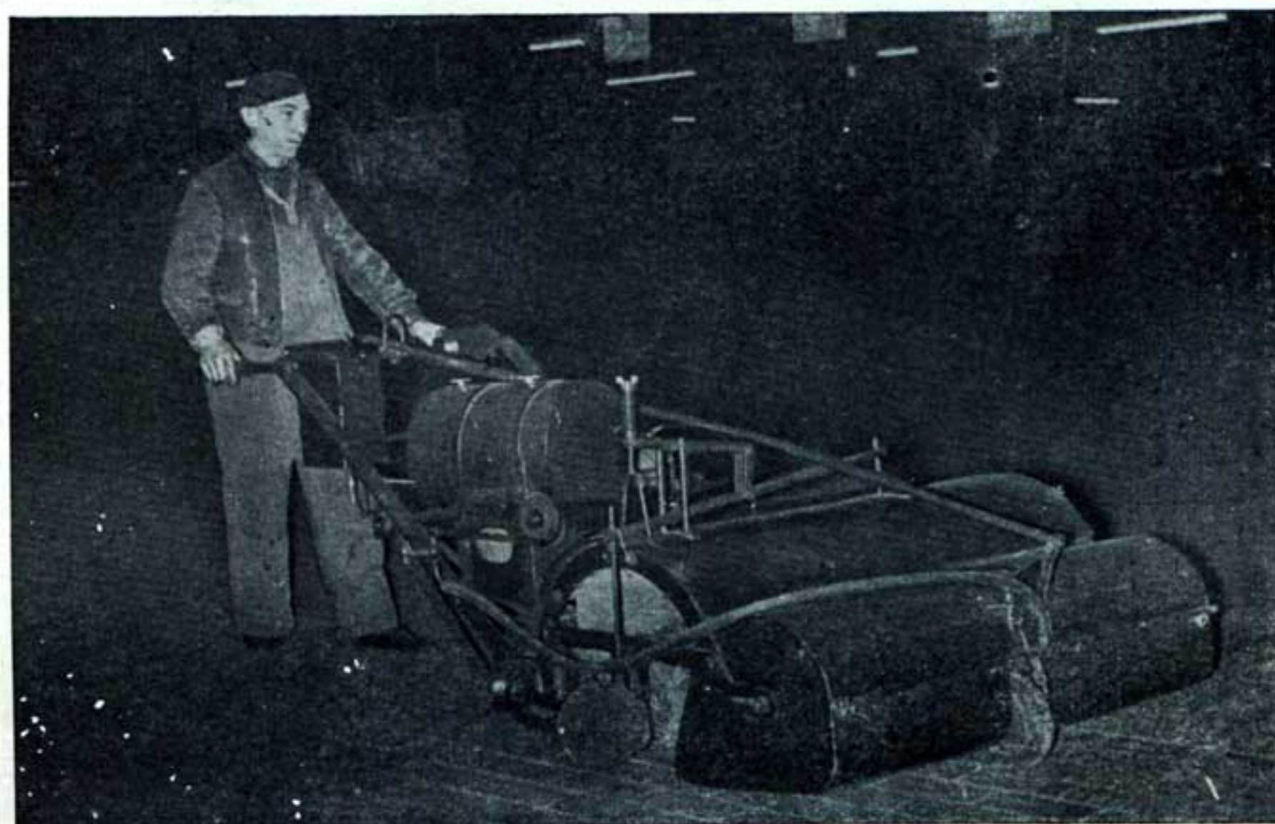
Balayeuse-ramasseuse Lewin avec moteur à essence.
