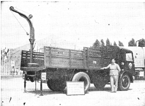
Fig. 5. — Vrachtwagen met draaikraan gebruikt bij de Franse spoorwegen.
