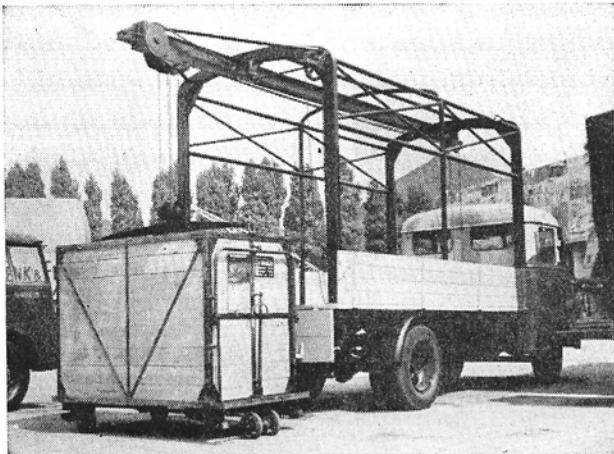
Fig. 4. — Vrachtwagen met kraan, gebruikt bij de Duitse spoorwegen.
