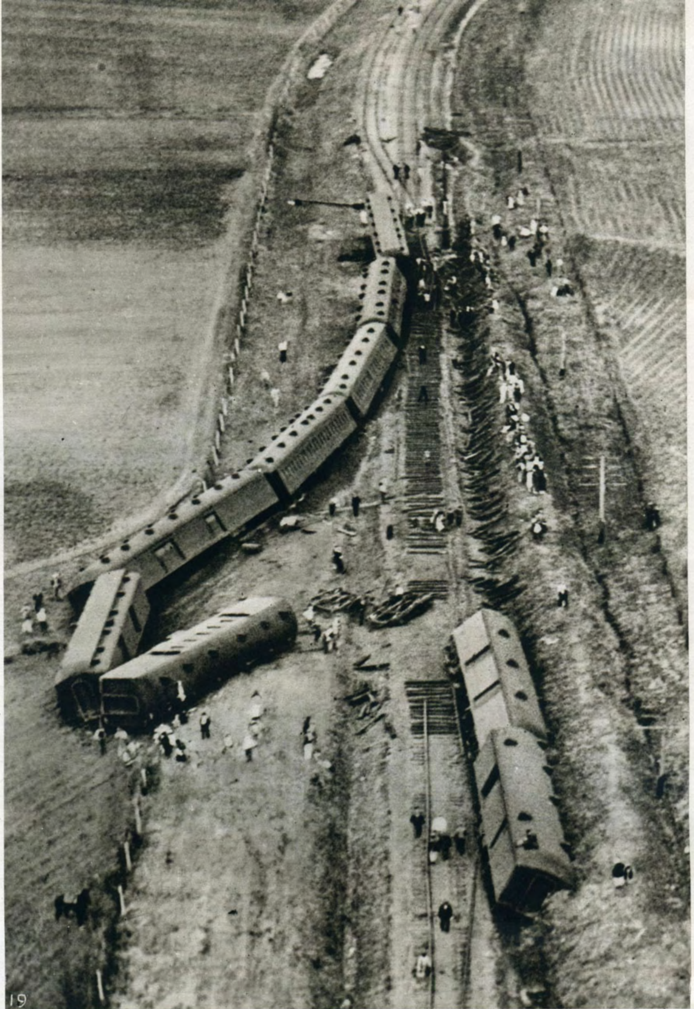
FIG. 19. VUE D'ENSEMBLE D'UN DERAILLEMENT AVEC TRAIN COMPOSE DE VOITURES METALLIQUES AUX ETATS-UNIS. (PHOTO « ACTUALIT ».)
