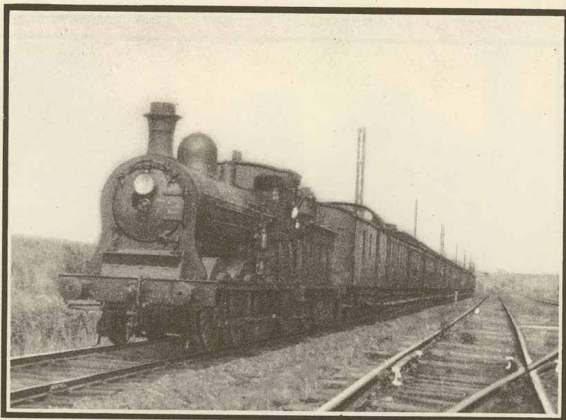
TRAIN REMORQUÉ PAR UNE LOCOMOTIVE TYPE 44 SUR LA LIGNE ANVERS-SAINT NICOLAS (WAES).
