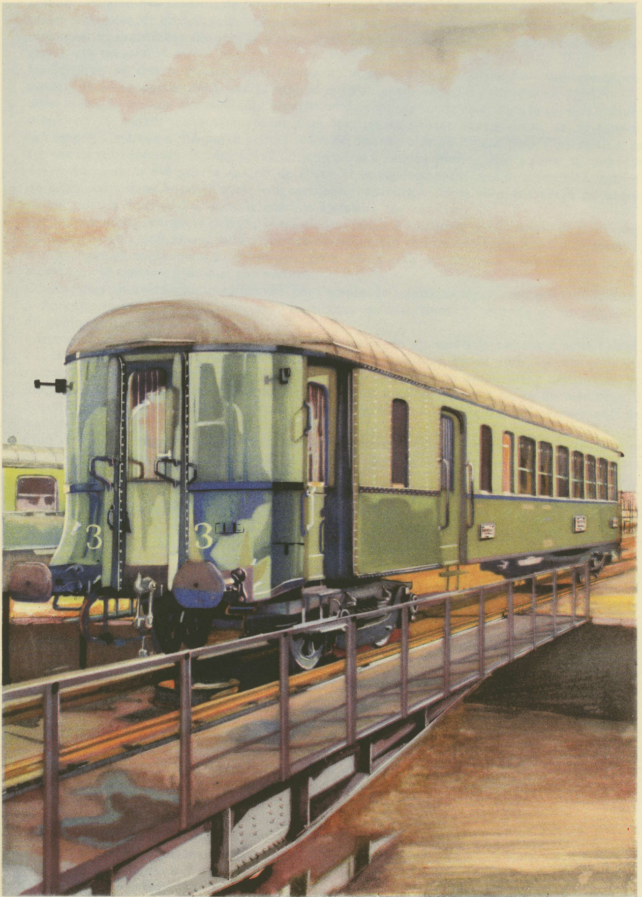
VOITURE MÉTALLIQUE MIXTE DE 3 e CLASSE TYPE « BLOC »
