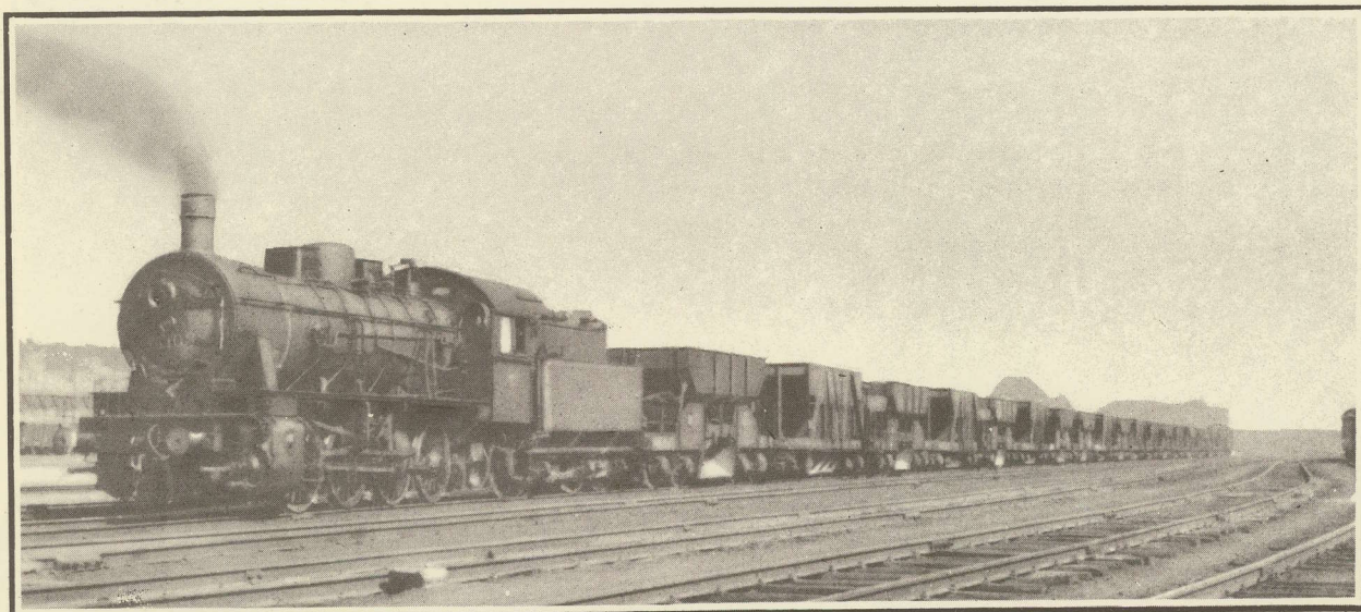
TRAIN DE MINERAI DE FER, COMPOSÉ DE WAGONS A DÉCHARGEMENT AUTOMATIQUE
