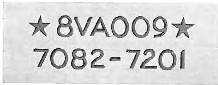
Fig. 5bis - Exemple de Nos de modèle et d'unité frappés dans le bloc moteur
