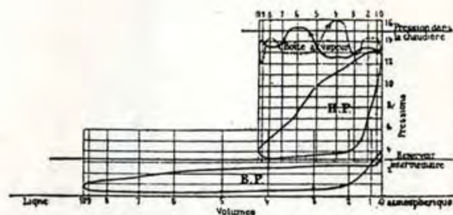
Diagramme relevé sur la machine compound 2158 du Chemin de fer du Nord, montrant aussi la pression dans la boîte à vapeur
