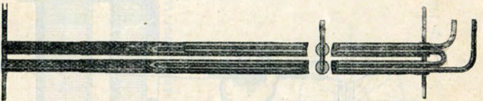
Tubes à fumée et élément pour surchauffeurs type « C » et « D ».
