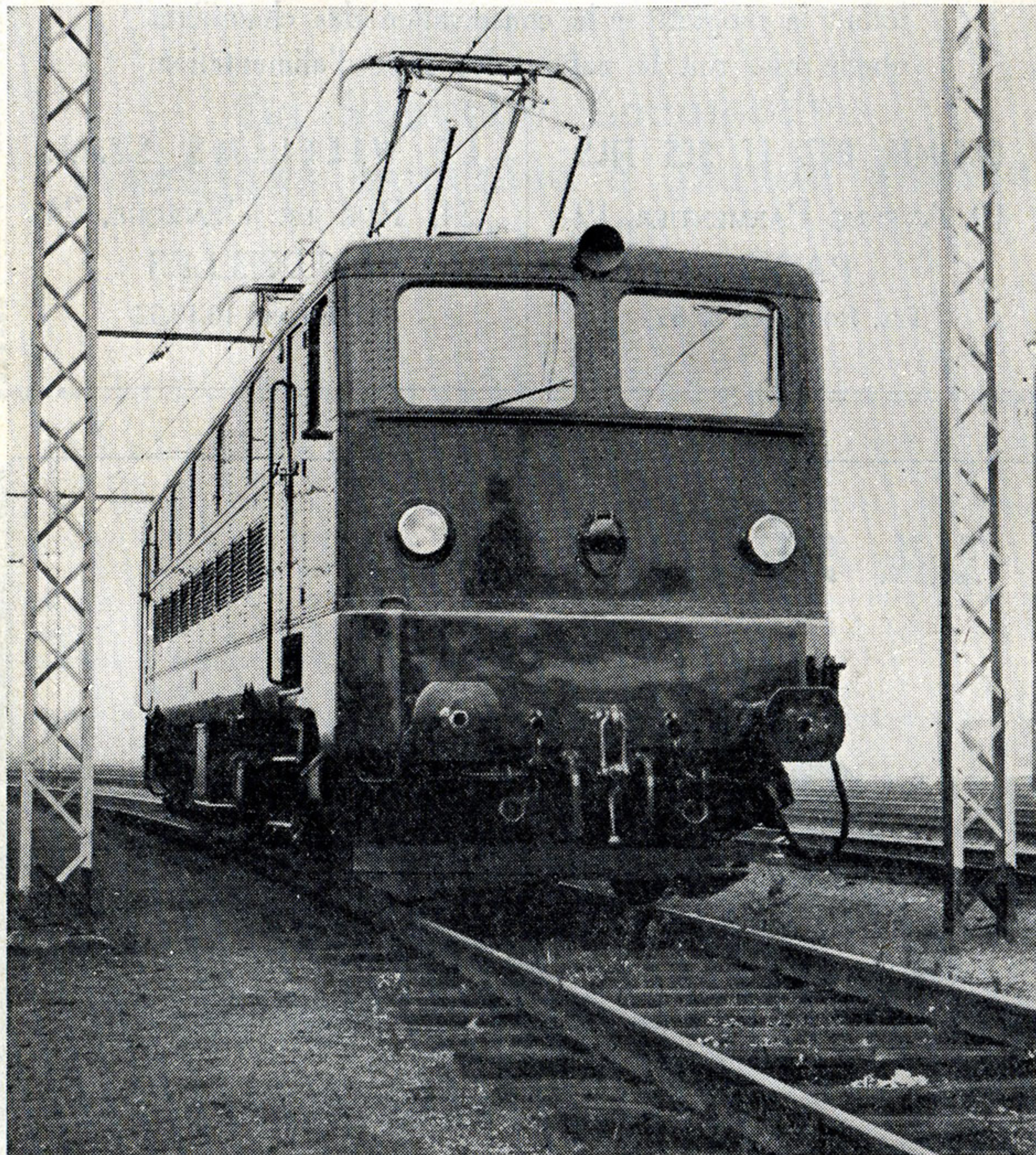
La BB type 121 de 2800 CV., vitesse 120 km/h.
