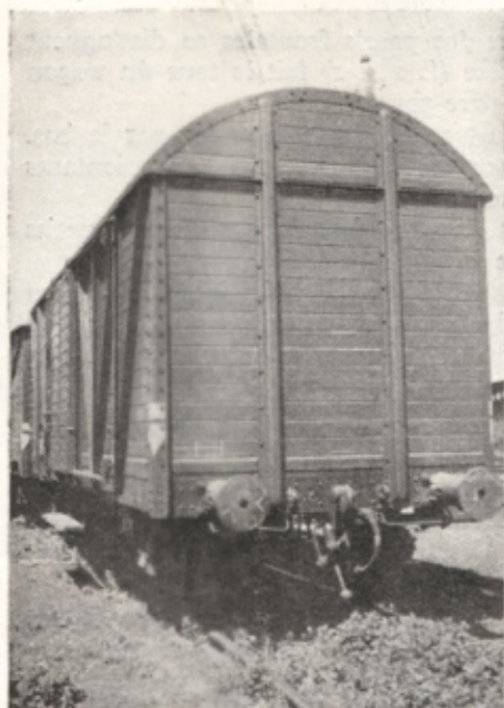
Modèle au 1/43 e du wagon fermé de 20 T., série 455.000 de la S. N. C. B., construit M. M. Bergdoll. (Photo H. F. Guillaume.)
