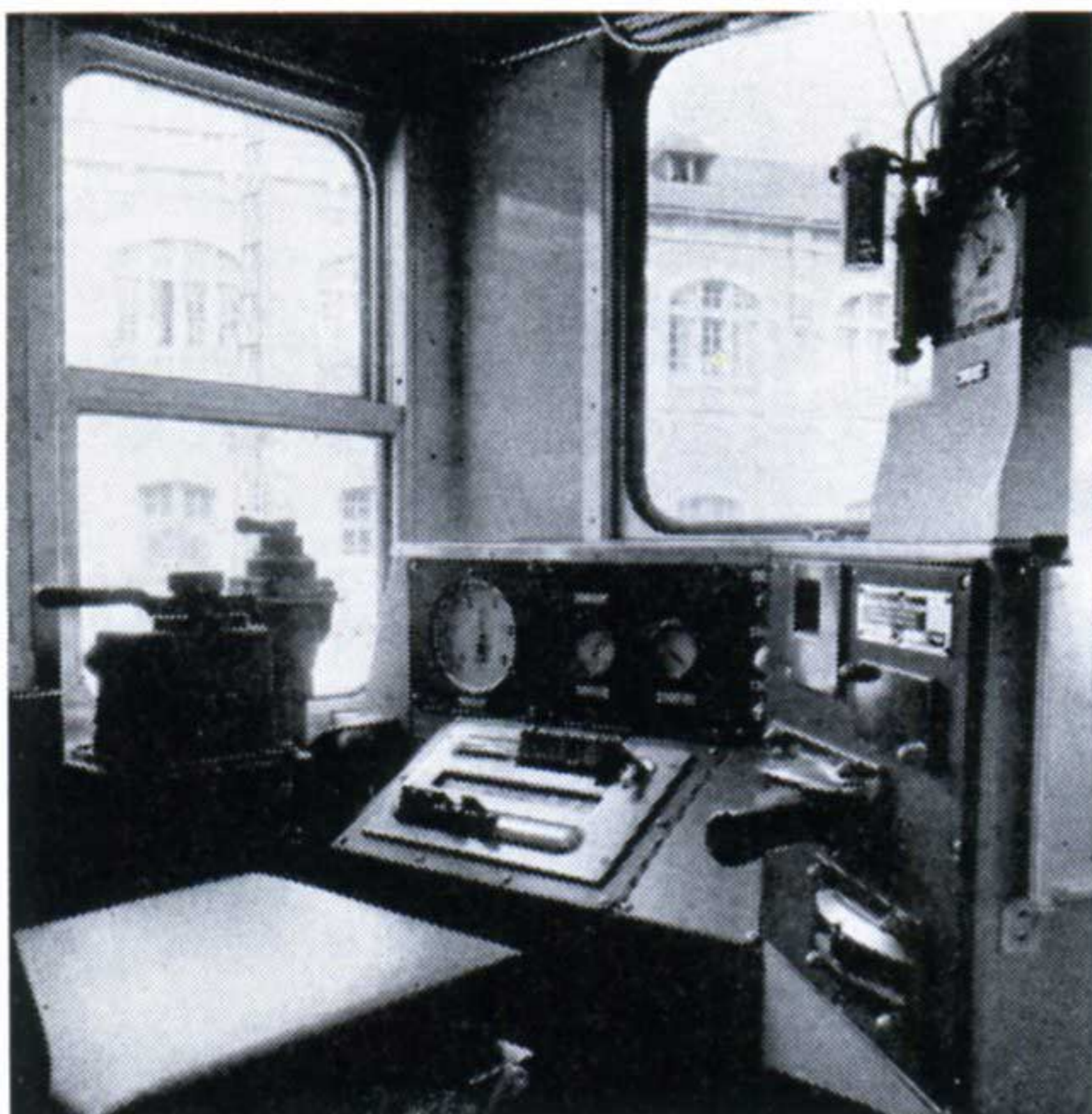
Poste de conduite en bout de rame, identique à celui de la locomotive.
