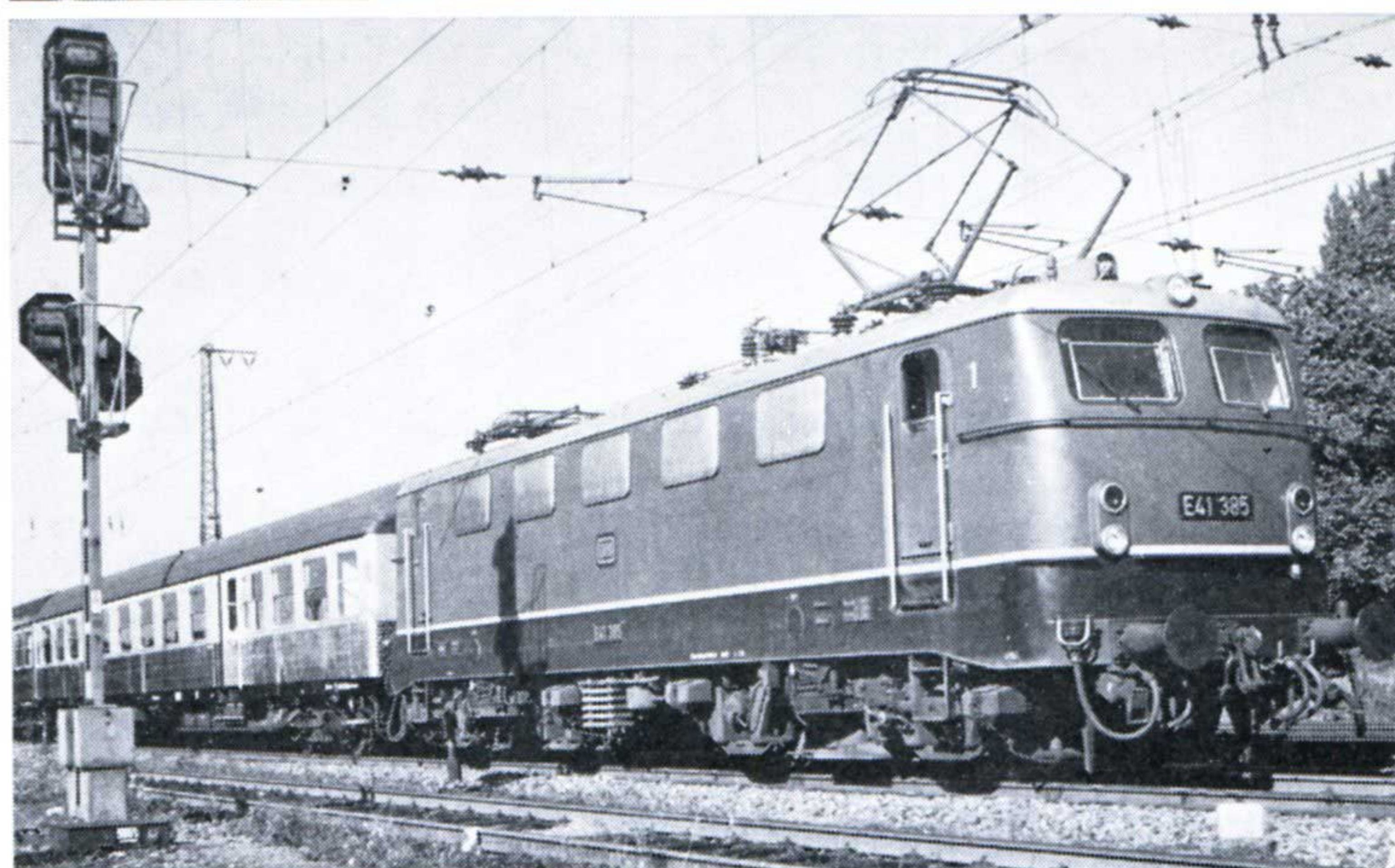
De haut en bas : rame réversible de la banlieue d'Hannover vue coté fourgon et la même vue coté locomotive, ici du type E 41. (photos D.B.)
