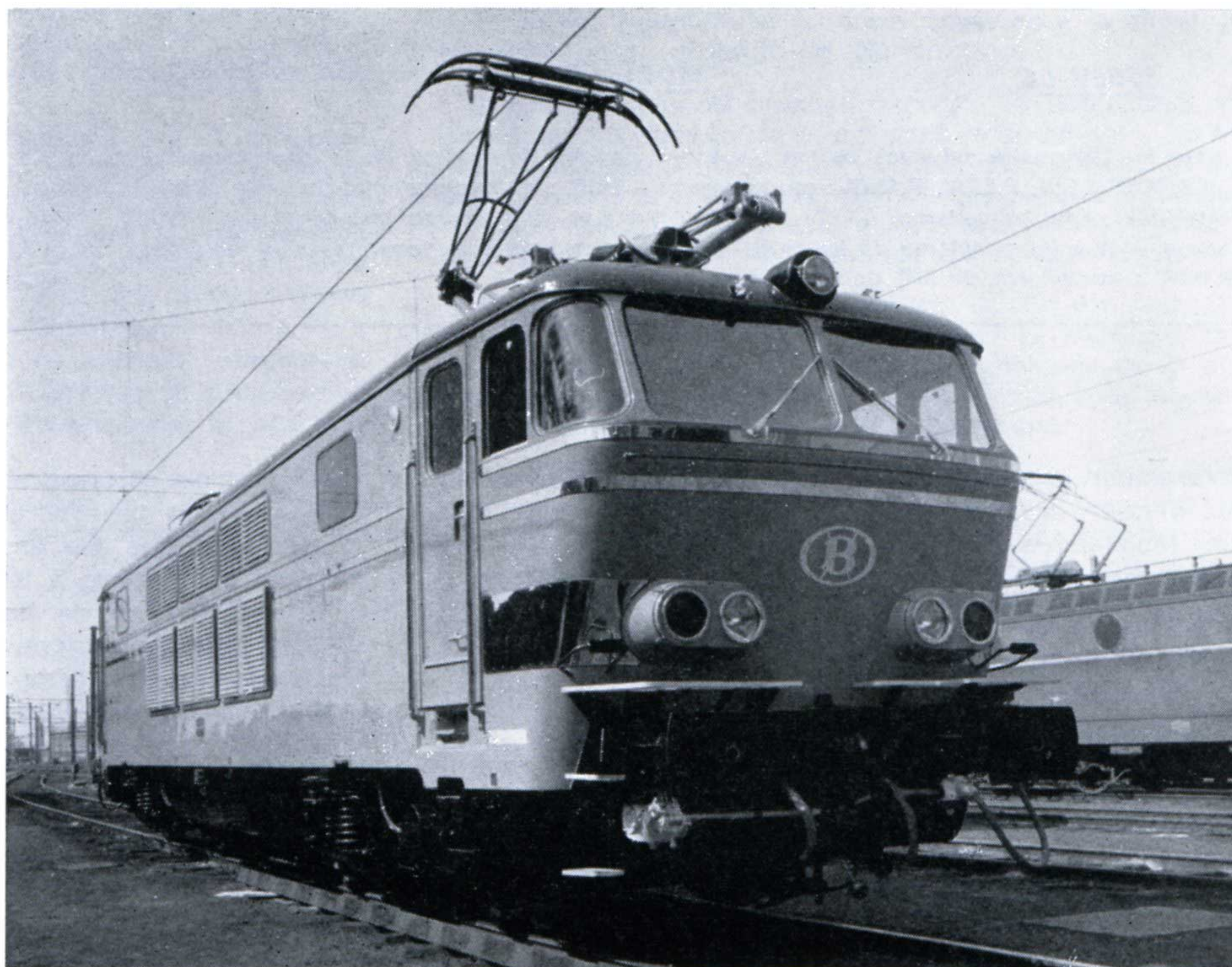
Figure 2 - vue d'ensemble de la locomotive électrique BB quadricourant type 160 de la S.N.C.B.
