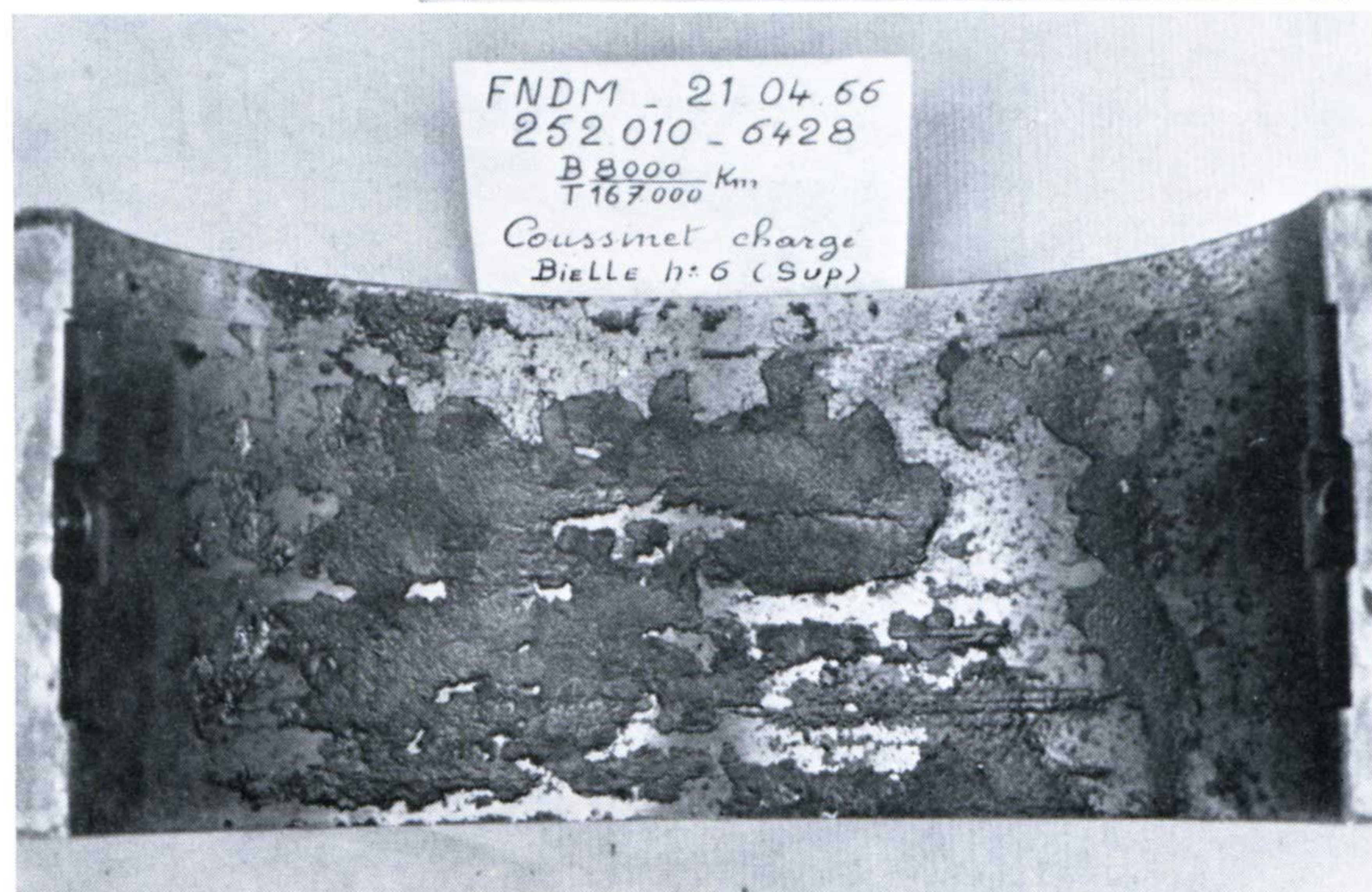
Fig. 7 - coussinet chargé de la machine 252010 stoppée le 21 avril 1966. (photos des auteurs.)
