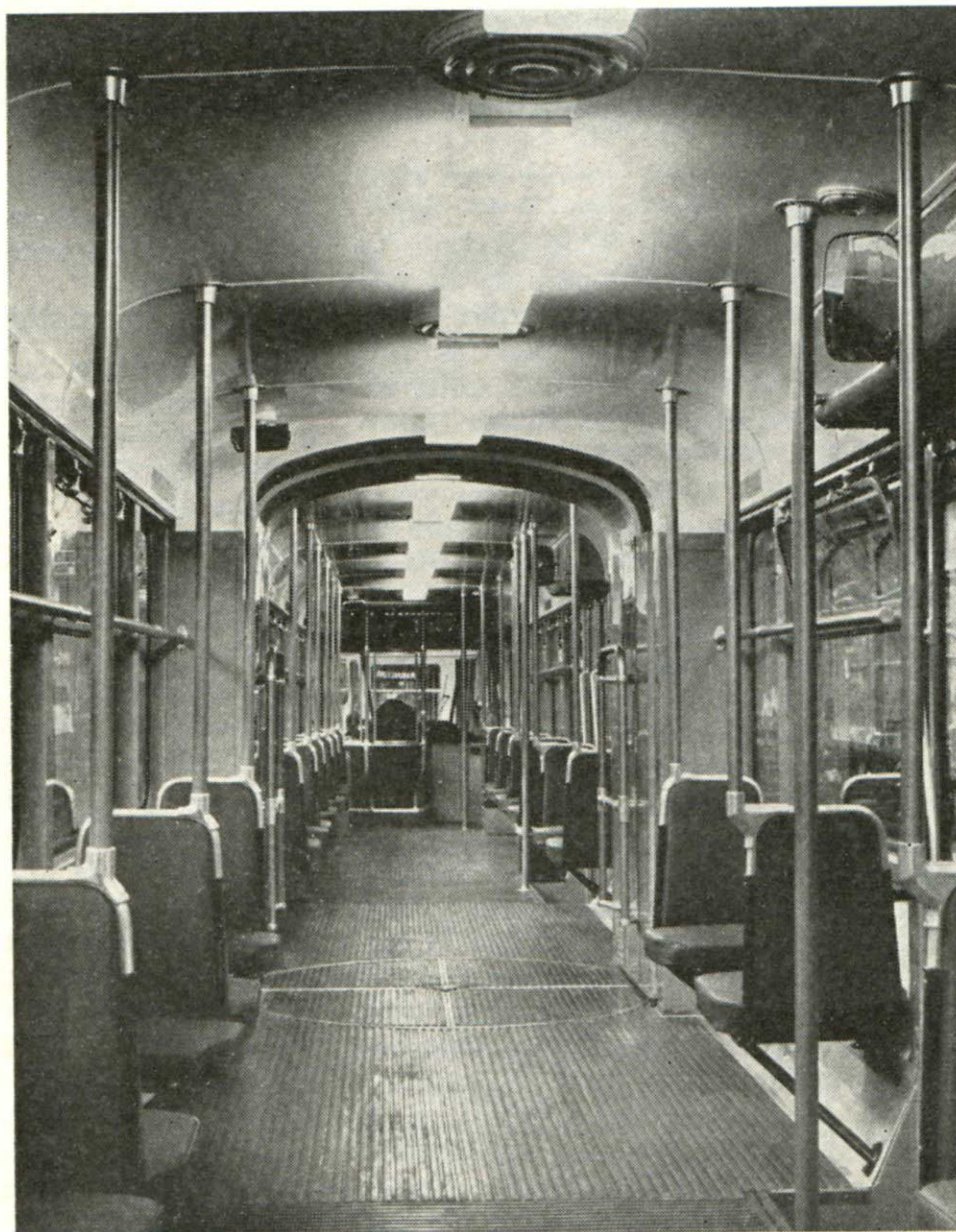
fig. 4 - vue intérieure vers l'avant; on distingue le disque d'articulation et, à l'arrière-plan, le poste de conduite.
