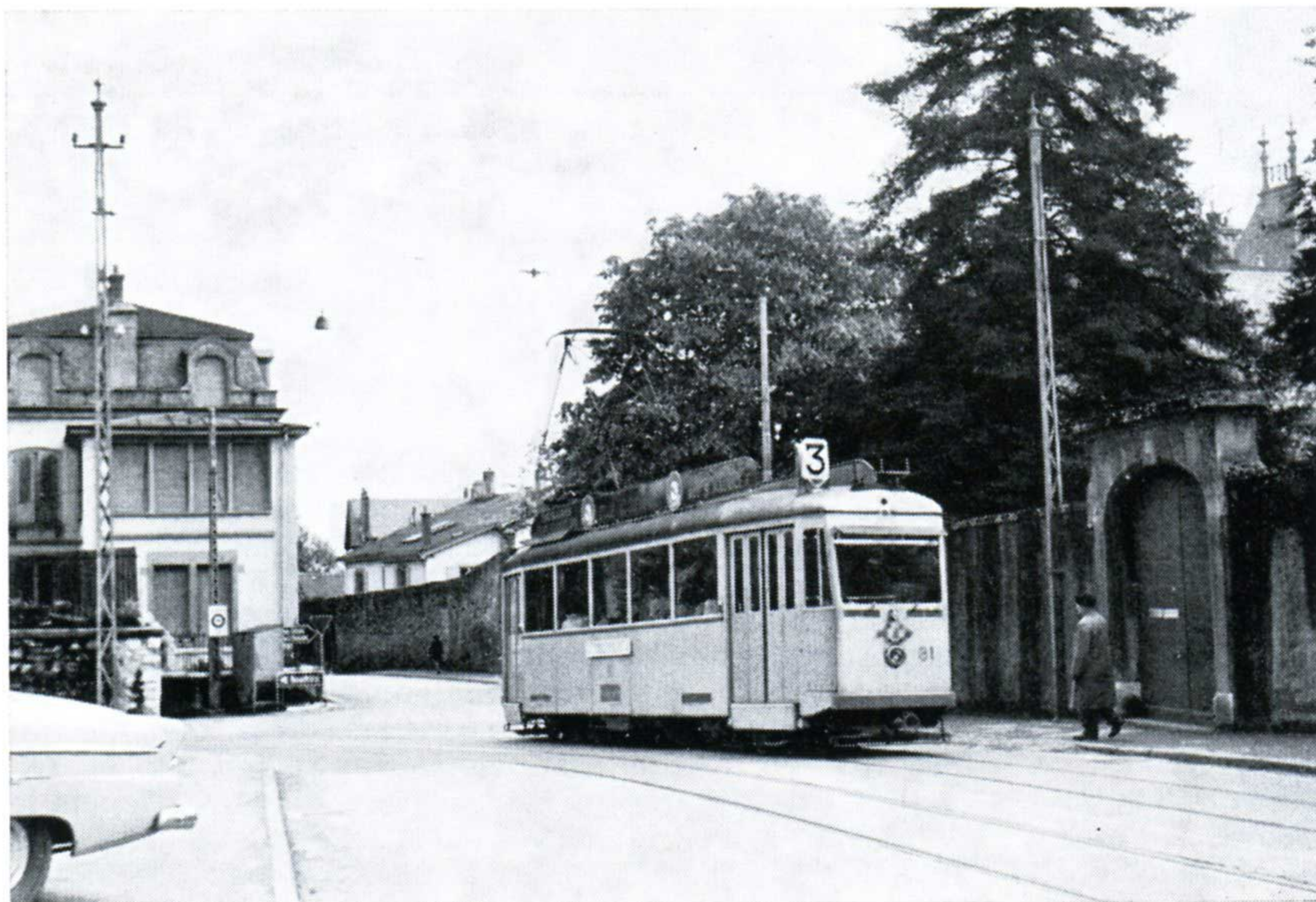
motrice à 4 essieux et bi-directionnelle, série 81-83 construite en 1947 (photos de l'auteur)
