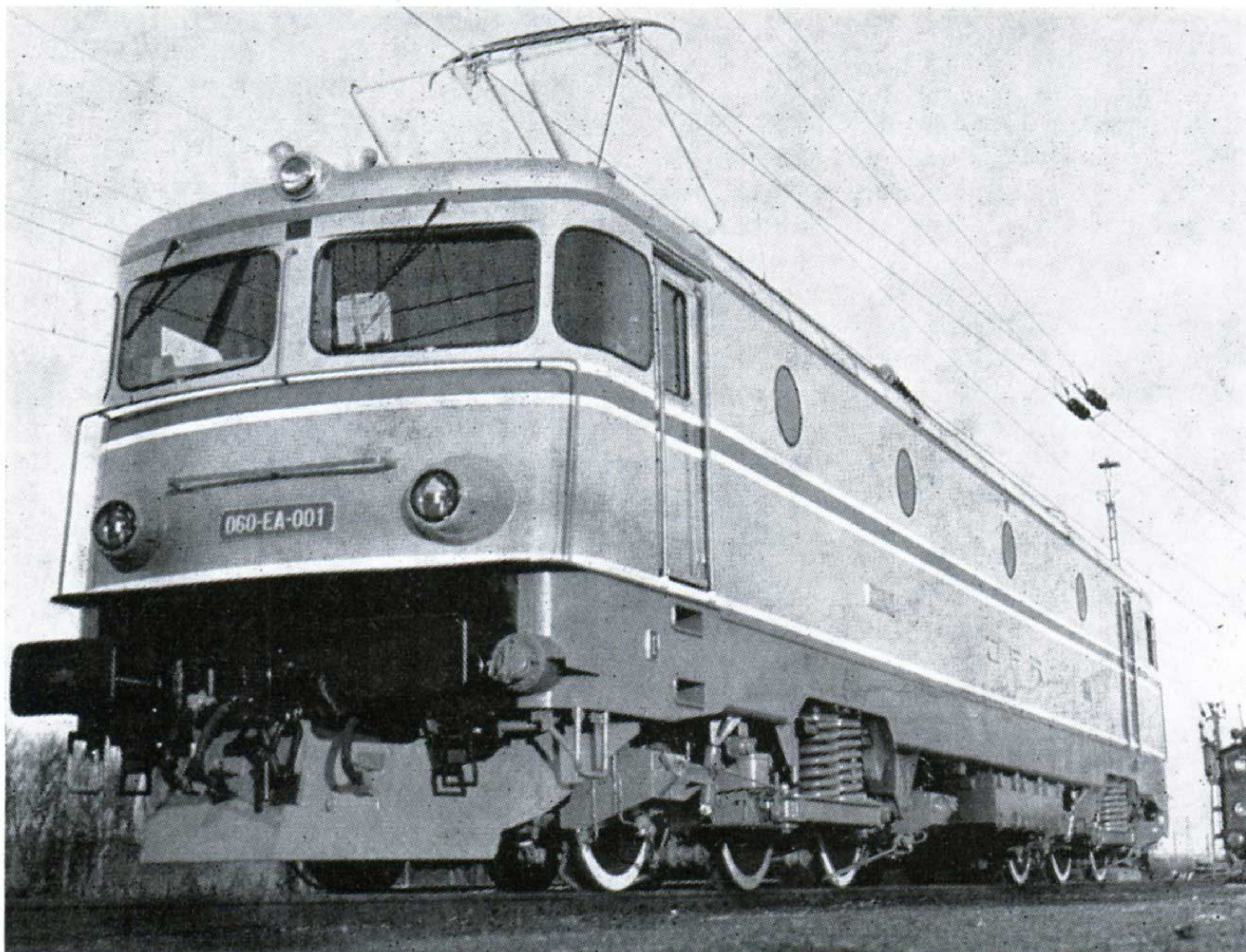
Locomotive CC - 25 kV 50 HZ de 5.100 kW - 120/160 km/h, de conception suédoise. (d'après document ASEA)
