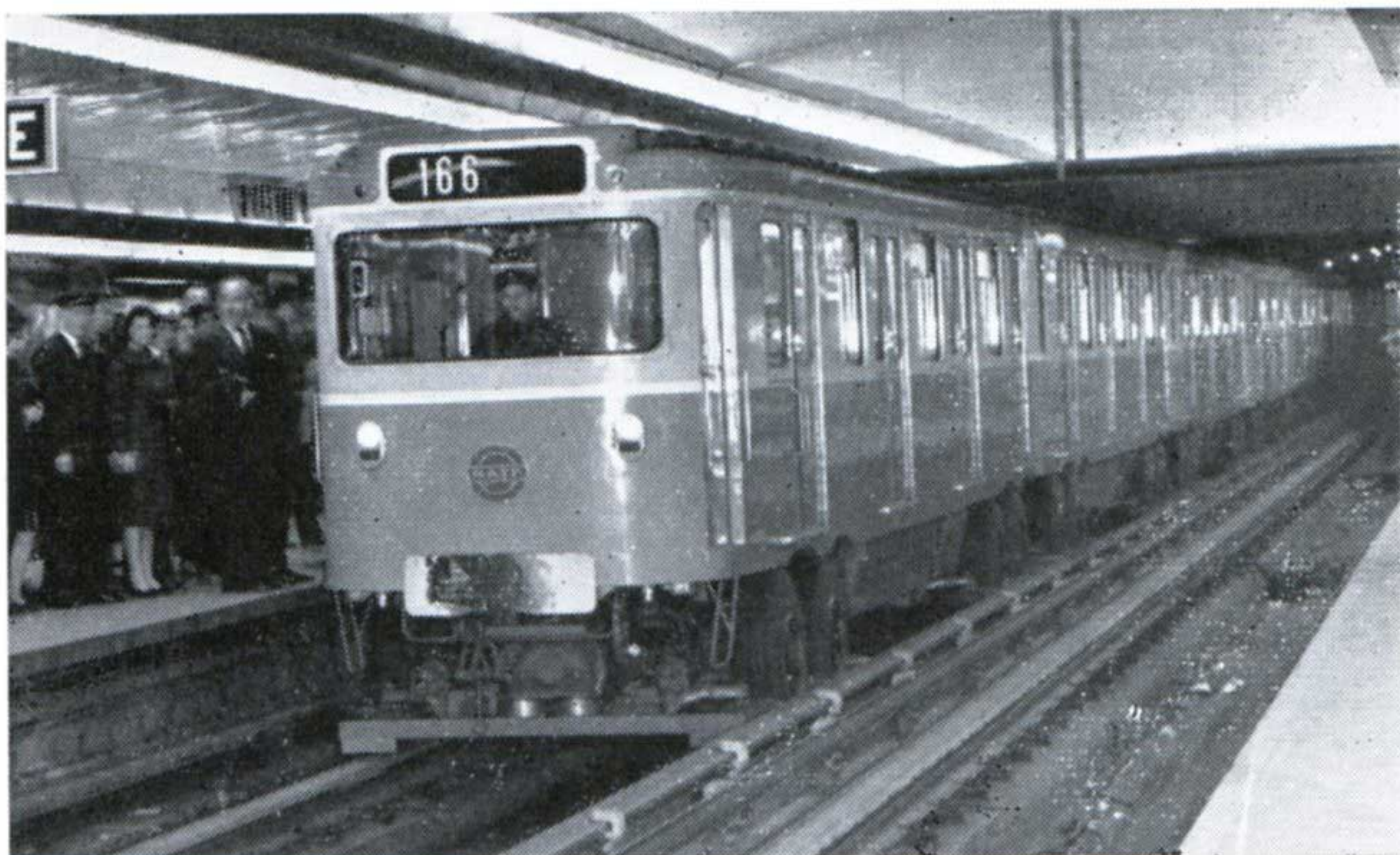
A gauche, une rame sur pneumatiques à quai dans la station « Franklin Roosevelt » sur la ligne n° 1; à droite, les trottoirs roulants de la station « Châtelet » (photos R.A.T.P.)
