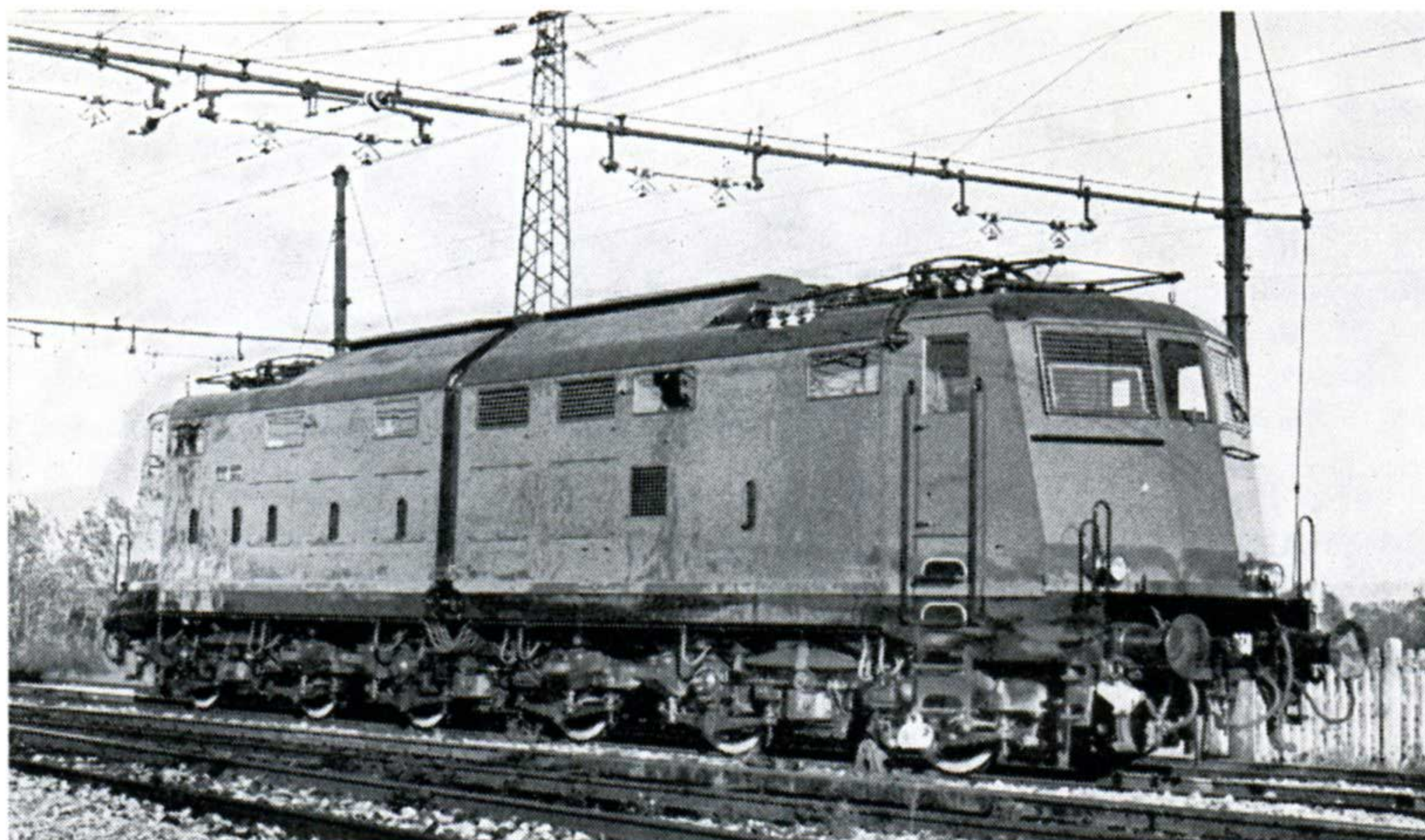
Locomotive mixte Gr.E.636 à courant continu 3000 Volts quittant les usines du constructeur à l'époque où la gare de Torino ne connaissait que les caténaires triphasées.
