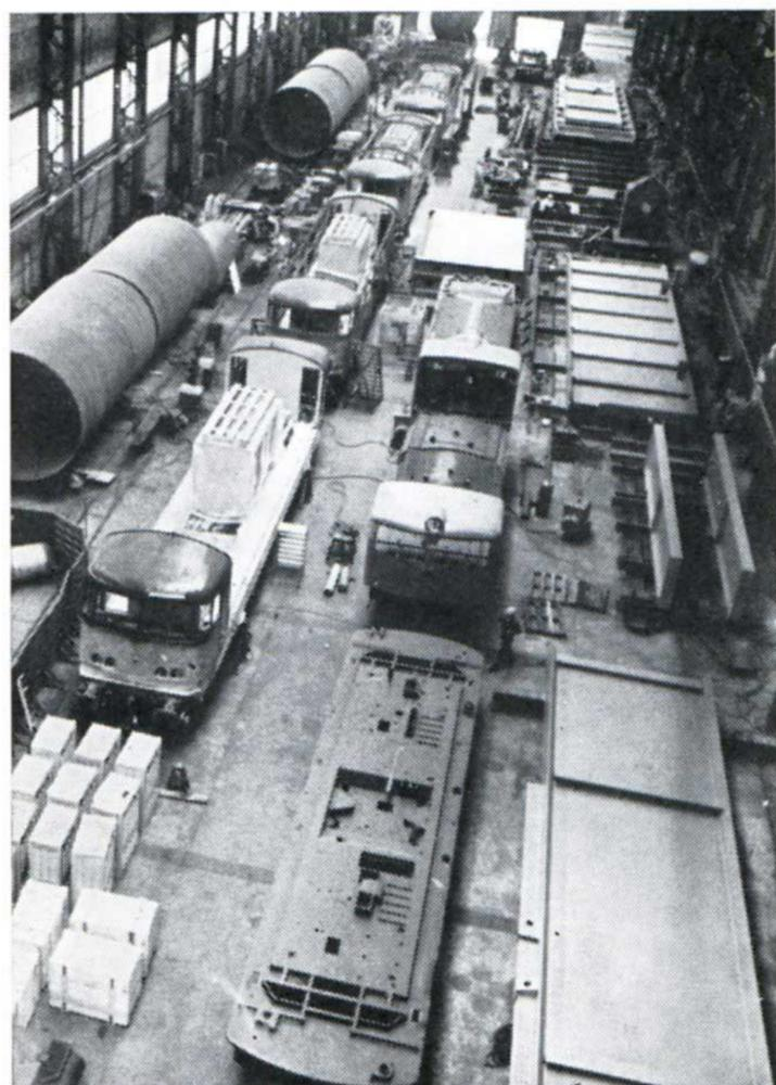
Dans l'usine de Nivelles de la S.A. La Brugeoise et Nivelles, la construction des locomotives BB126 pour la S.N.C.B. est en cours (à gauche) conjointement avec celle d'une autre série pour la République du Congo, réseau du B.C.K., électrifié comme chacun sait, en 25 kV 50 Hz.
