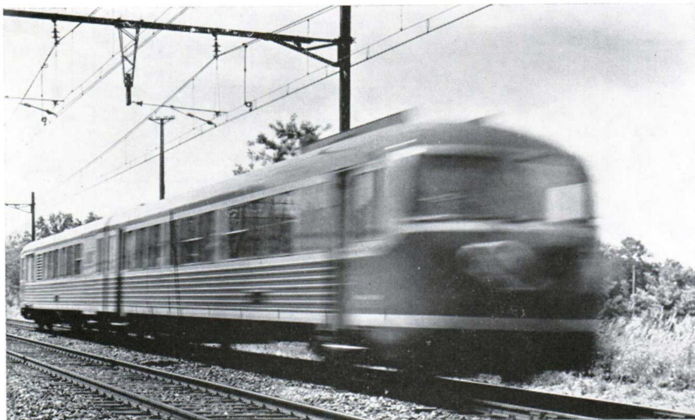
L'engin expérimental à turbine à gaz en essai de vitesse
