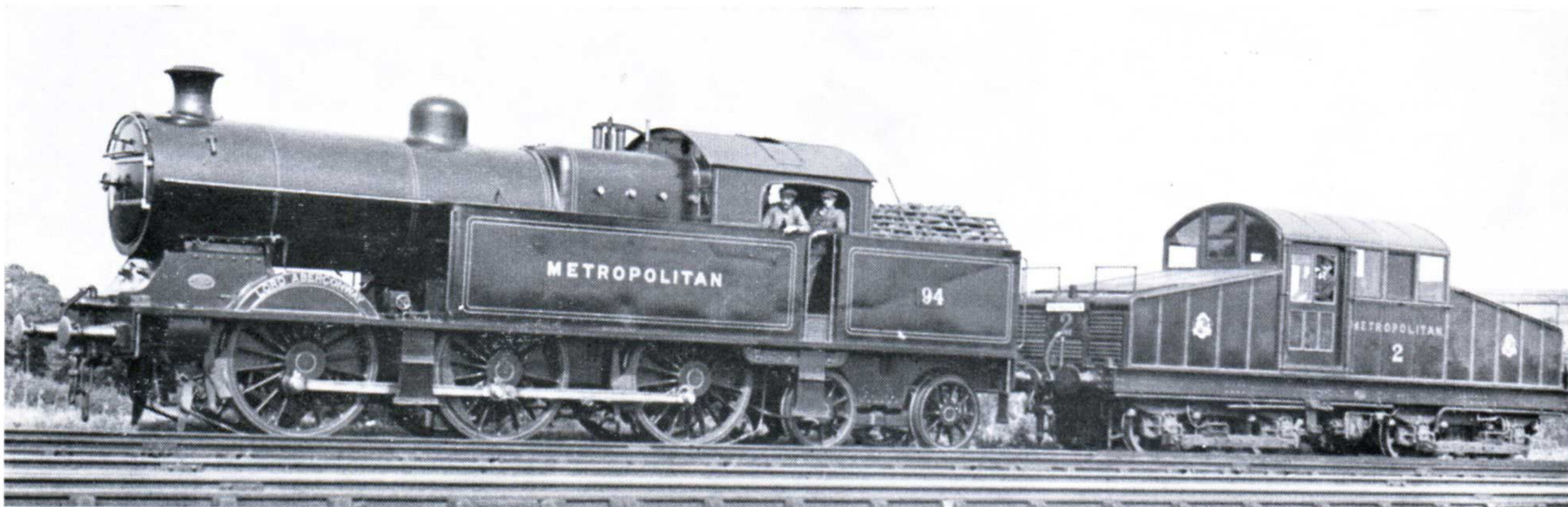
Locomotive à vapeur 0-6-4T (classe G) construite en 1915 et locomotive électrique BB (boîte à sel) de 1905, toutes deux de la Metropolitan. (photo London Transport Board)
