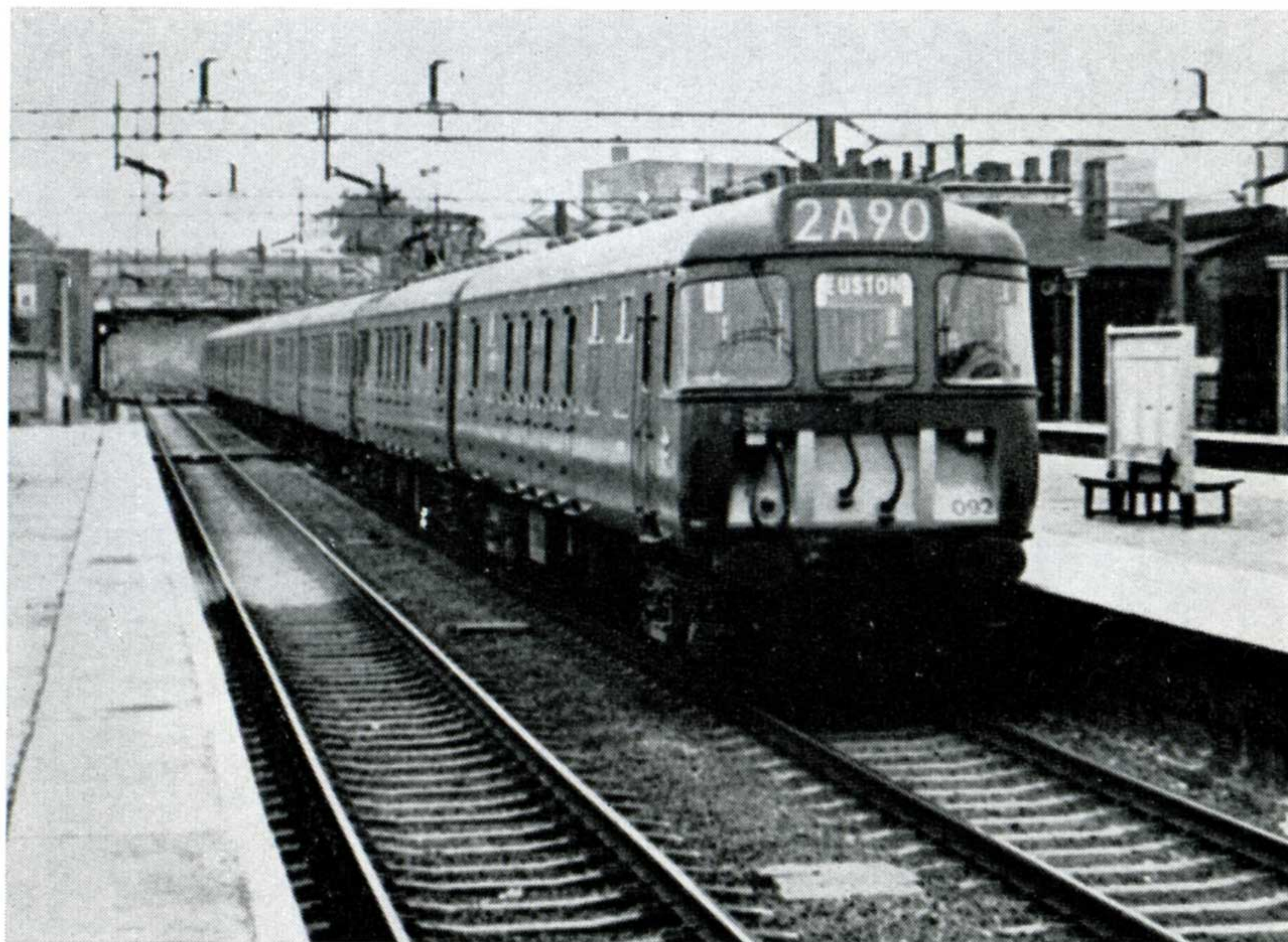
Automotrice de banlieue 25 kV 50 Hz de la London Midland Region à Watford, terminus Nord de la « Bakerloo Line ». (photo de l'auteur)
