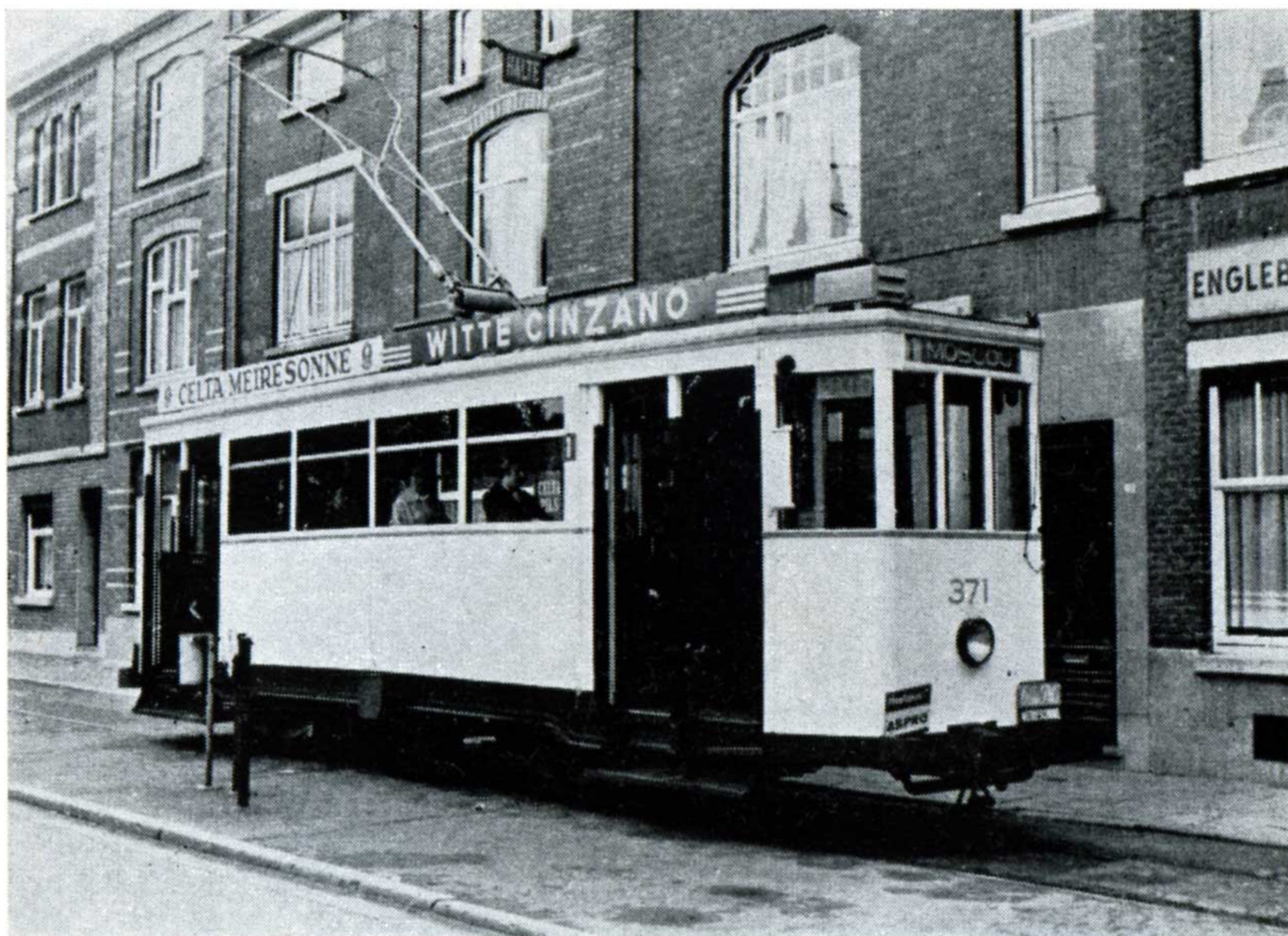
Motrice standard à trois essieux radiants; dernier type de tramway belge sans portes et avec archet (photo de l'auteur)
